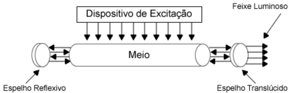
Figura 3.5 – Estrutura genérica de um laser .
