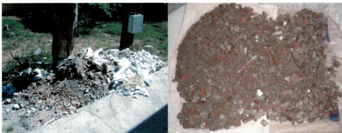
Figura 2 - Resíduo de Construção e Demolição do Bloco CT, UFCG.
