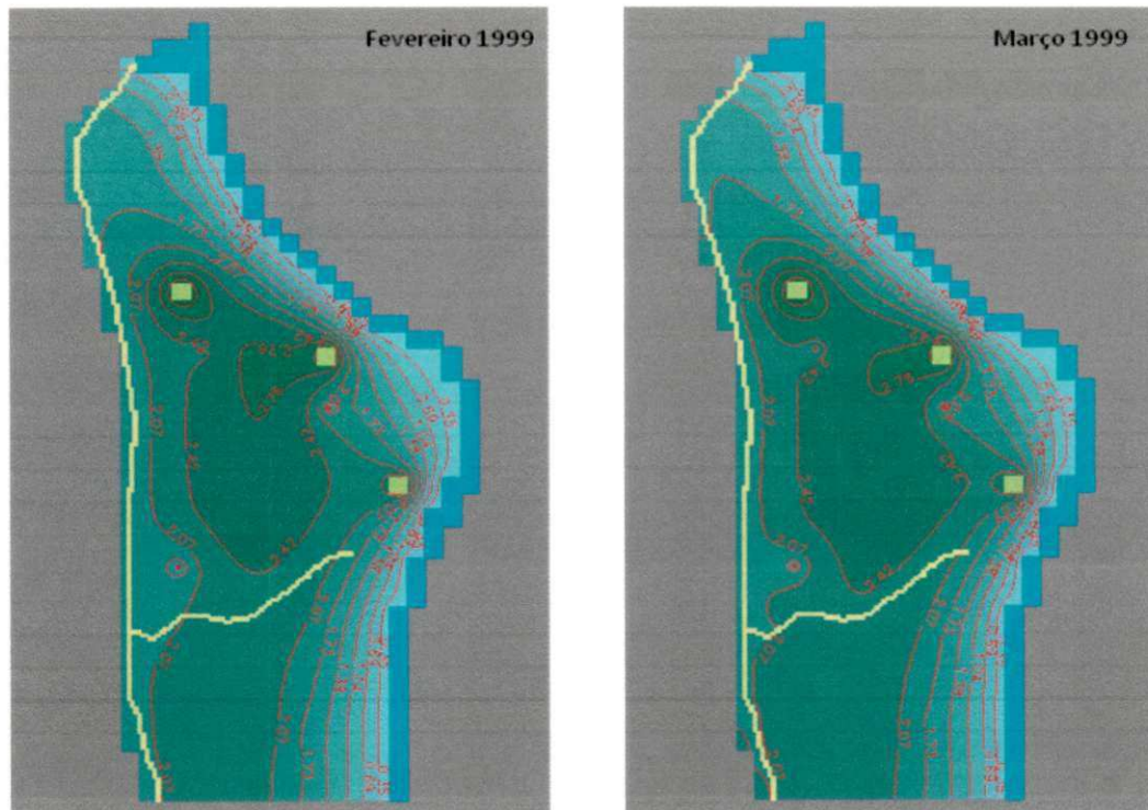
Figura 5.24 – Níveis piezométricos referentes às medições de fevereiro e março de 1999.
