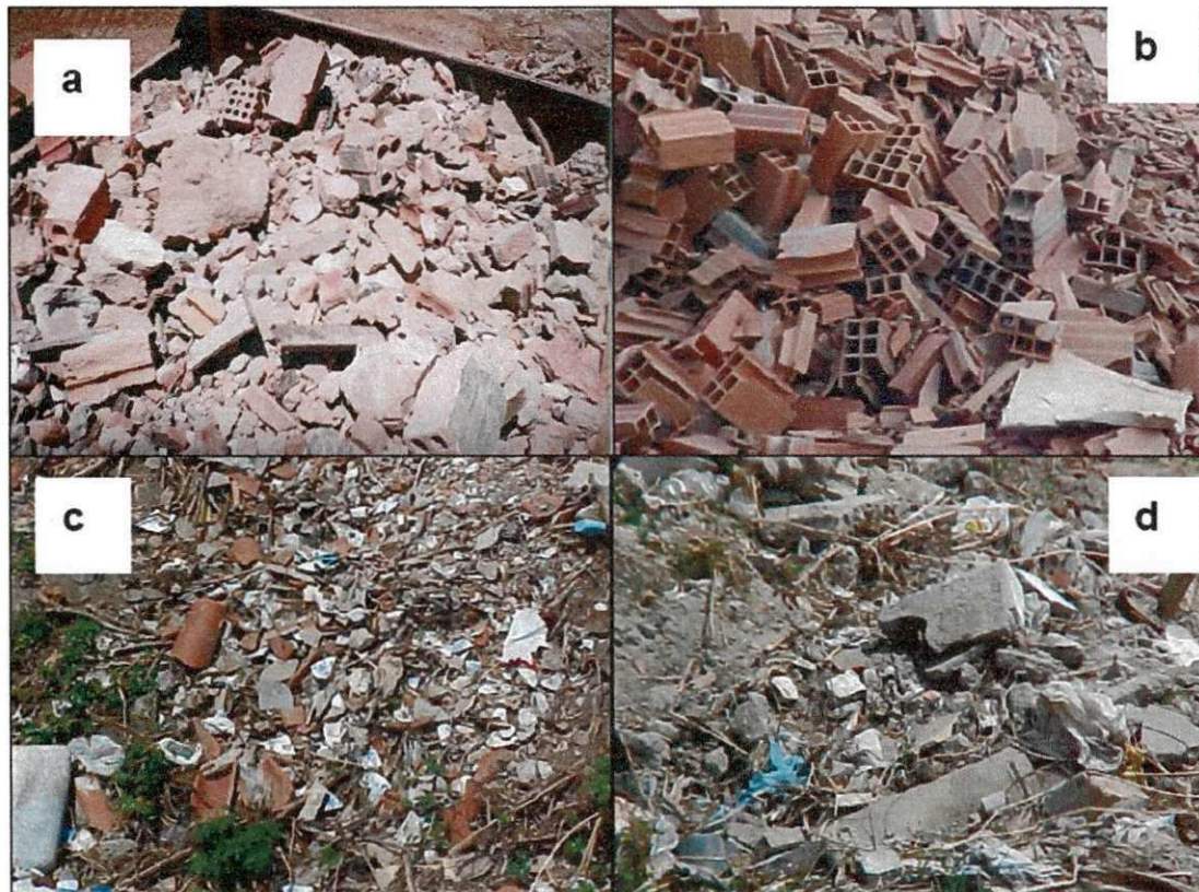
Figura 2 – Resíduos de construção (a) e (b); resíduos de demolição (c) e (d)
