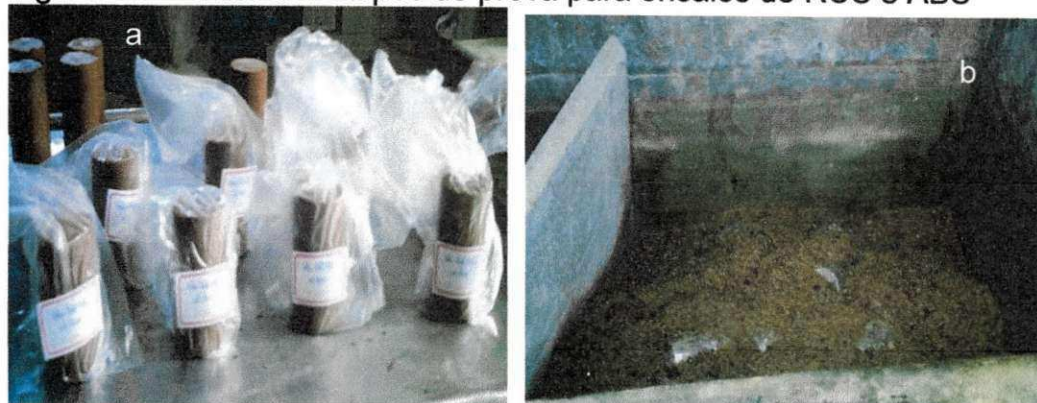
Figura 3.7 – Cura dos corpos de prova para ensaios de RCS e ABS
