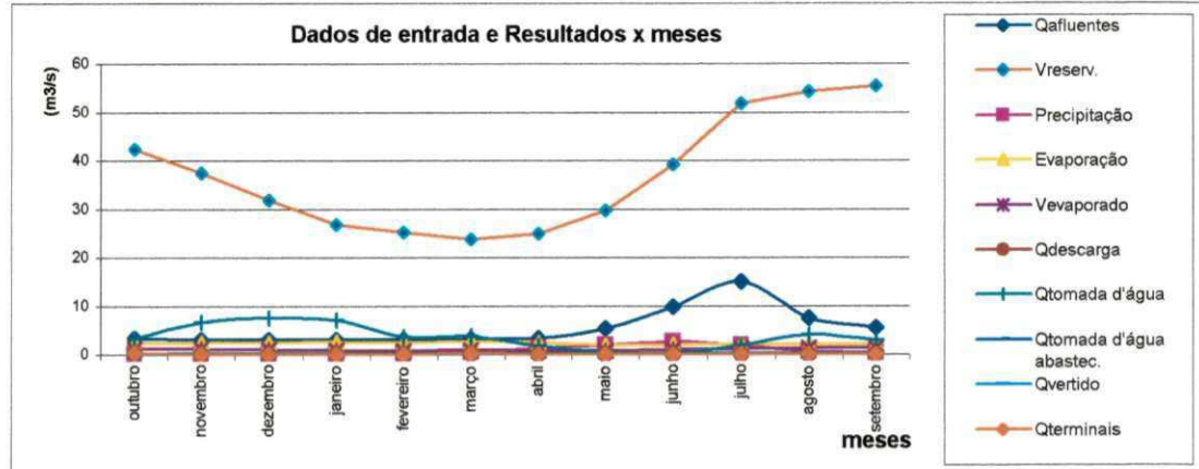
Figura 6.86 - Vazões afluentes e defluentes ao reservatório
