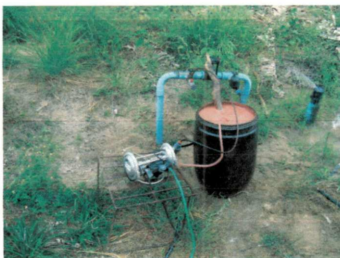
Figura 4. Aplicação de fertilizantes via água de irrigação utilizando bomba injetora de acionamento hidráulico
