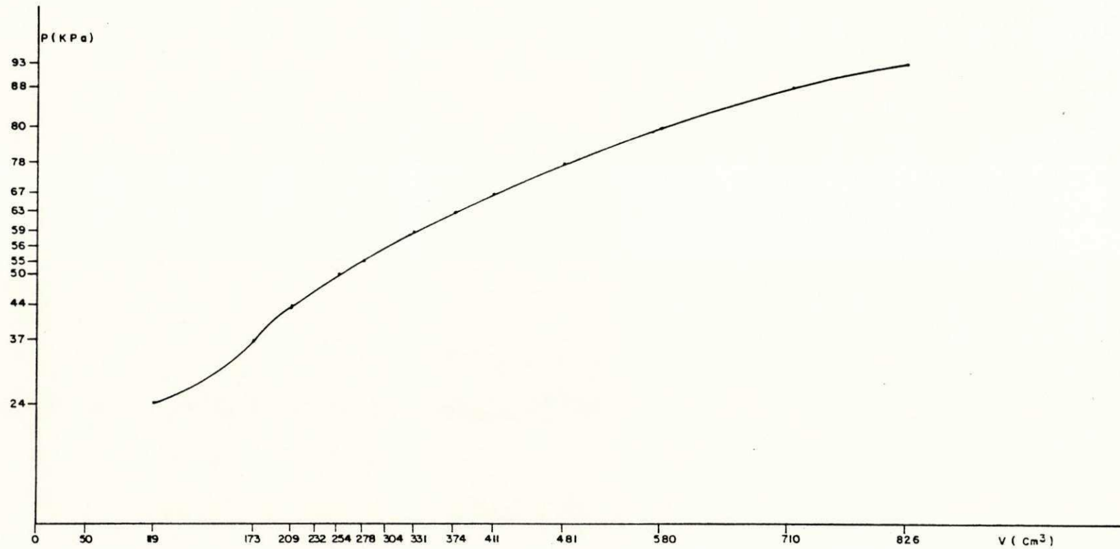
Fig. 4.3 -GRÁFICO DA CURVA DE CORREÇÃO DE PERDA DE PRESSÃO OBTIDA NO ENSAIO PRESSIOMÉTRICO REALIZADO NA PROFUNDIDADE DE 14,75m.
