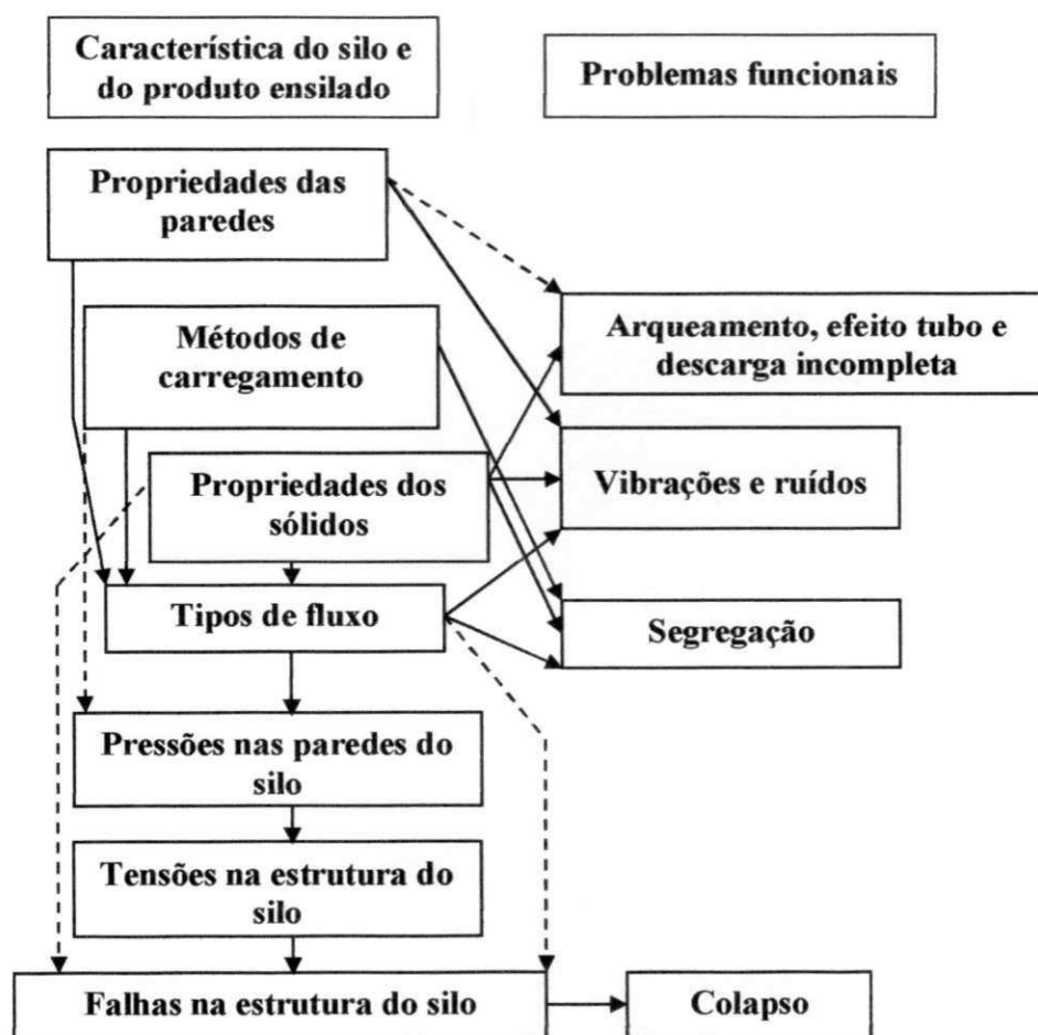
Figura 13. Problemas funcionais em silos e seus precedentes.
