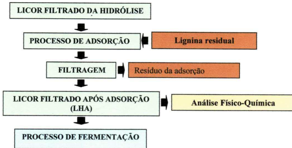
Figura 3.5 - Fluxograma do processo de adsorção de inibidores (destoxificação) do licor da hidrólise do bagaço do pedúnculo.
