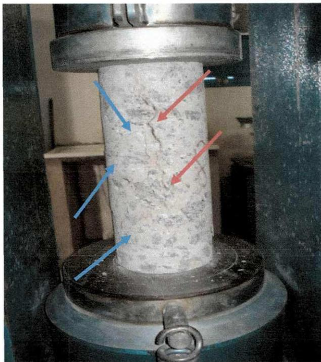
Figura 3.10 – Corpo de prova submetido à compressão axial.
