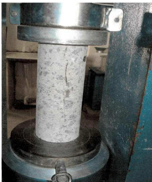
Figura 3.9 – Corpo de prova submetido à compressão axial.
