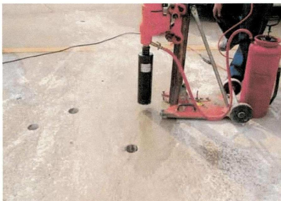
Figura 2.9 – Extração de corpo de prova após injeção sobre fissura.
