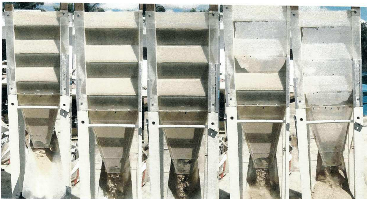
Figura 87– Comportamento da bentonita durante a descarga com seção de descarga de 100\text{cm}^2
