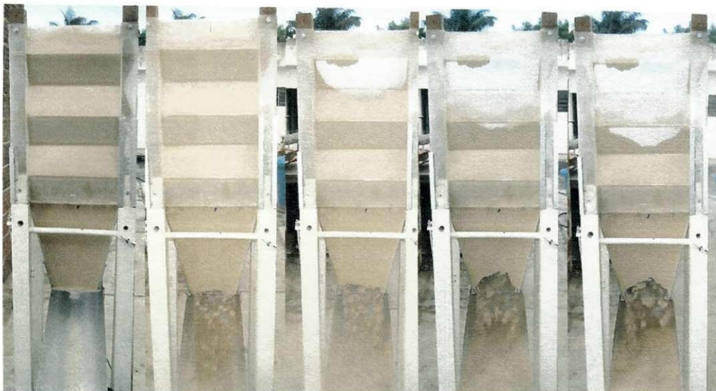
Figura 89– Comportamento da bentonita durante a descarga com seção de 256 cm 2
