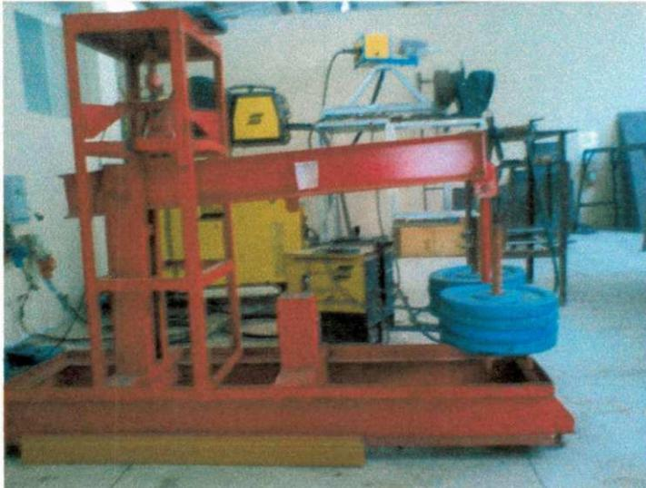
A máquina é composta de uma célula de carga, um equipamento de aquisição de dados da carga, um macaco hidráulico de 3 toneladas, um suporte para anilhas responsável pela carga aplicada, 2 anilhas de 2Kg, 2 anilhas de 3Kg, 2 anilhas de 4Kg e 18 anilhas de 10Kg, como mostrado na Figura 22. Os detalhes do aparelho de aquisição dos dados, do macaco hidráulico e da posição do corpo de prova estão apresentados na Figura 23.
