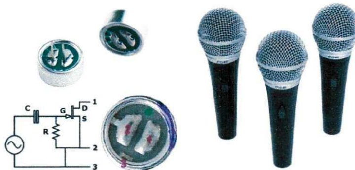
Figura 60 - Microfones de eletreto (esquerda) e dinâmicos (direita), comumente utilizados na captura de sinais de áudio, aplicam-se à técnica de resposta acústica a um impulso, para estimativa de firmeza de frutas.
