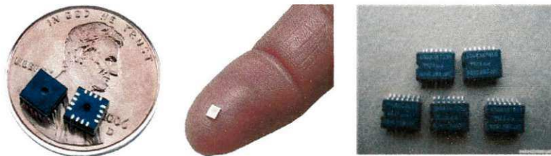
Figura 62 - Circuitos integrados sensores MEMS . À direita, chips do acelerômetro utilizado.
