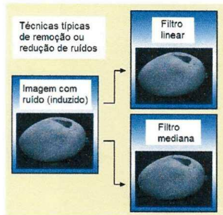
Figura 44 - Técnicas típicas de remoção ou redução de ruídos em imagens
