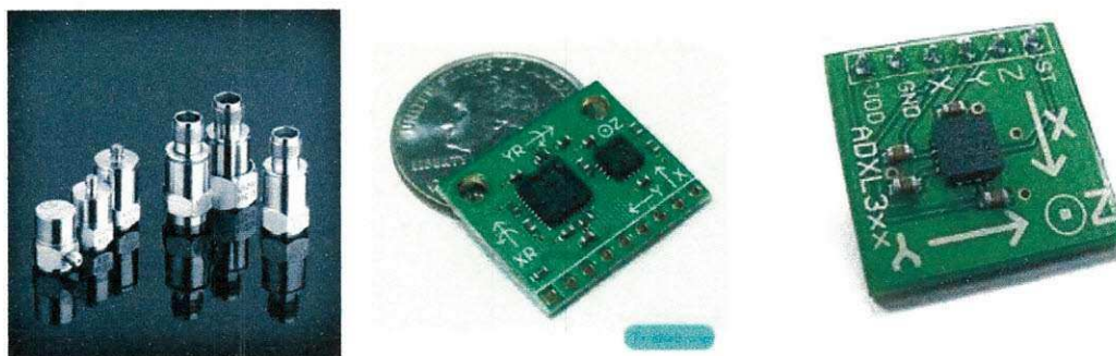
Figura 59 - Acelerômetros piezoelétricos (esquerda) e MEMS (centro e direita).
