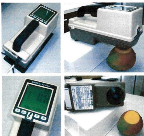
Figura 86 - Colorímetro Miniscan XE Plus ( Hunterlab ) e detalhes do processo de captura de cores das polpas das mangas.
