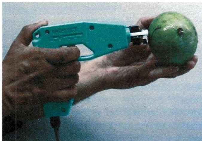
Figura 61 - Medidor de firmeza portátil, baseado na técnica de medição da velocidade do som na fruta. Fonte: SUGIYAMA et al. (2005)
