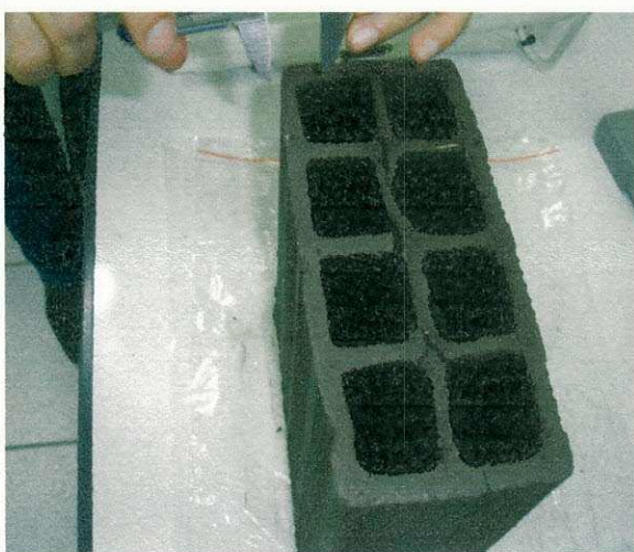
Figura 4.13 – Vistas da amostra submetida à secagem com temperatura constante de 100°C na estufa (t = 80 minutos).
