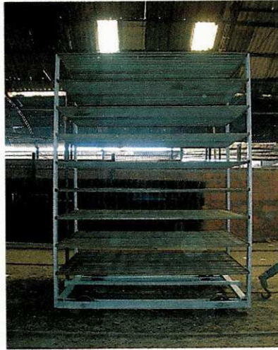
Figura 3.12 – Vagonetas usadas na secagem no secador industrial
