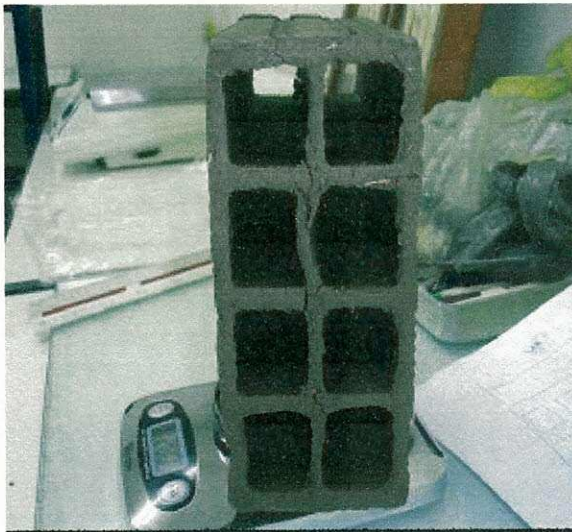
Figura 4.14a – Vista da amostra submetida à secagem em estufa com temperatura constante de 100°C (t = 140 minutos).
