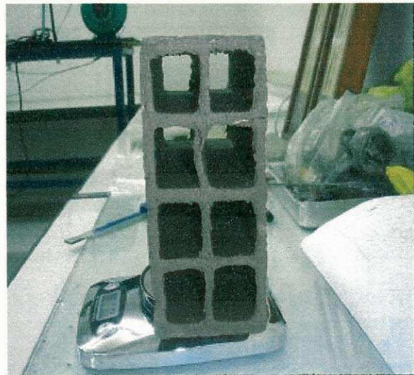
Figura 4.14b – Vista da amostra submetida à secagem em estufa com temperatura constante de 100°C (t = 200 minutos).
