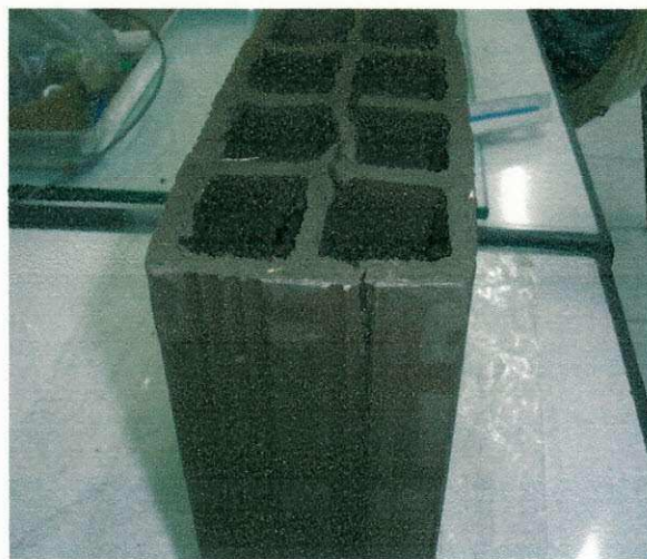
Figura 4.13 – Vistas da amostra submetida à secagem com temperatura constante de 100°C na estufa (t = 80 minutos).
