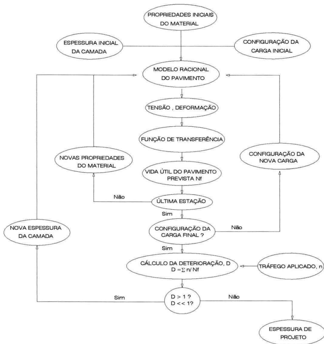
Figura 2.10 - Seqüência lógica do Modelo de dimensionamento racional (NCHRP, 1999).
