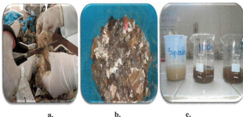
Figura 56 - a. Picotagem dos resíduos; b. Amostra com água destilada; c. Extrato dos resíduos identificados por camada
