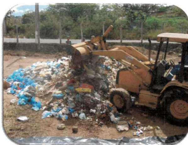
Figura 34 - Homogeneização dos resíduos
