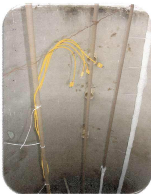
Figura 28 - Termopares fixados ao tubo de PVC
