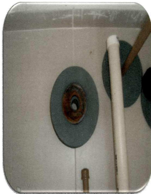
Figura 26 - Placas de Recalques em Profundidades
