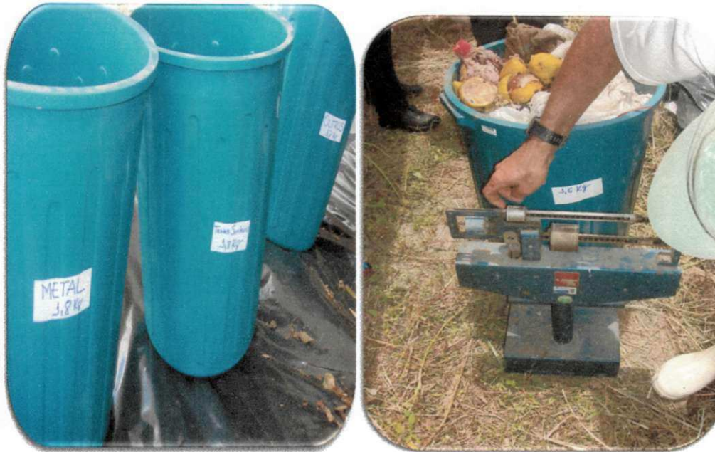
Figura 43 - Baldes identificados por categoria e pesagem após a triagem
