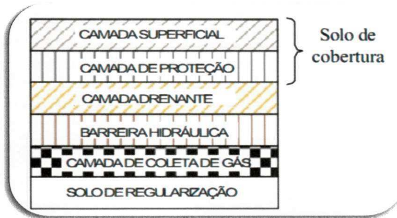
Figura 7 - Camadas do recobrimento final de um aterro sanitário (CARVALHO, 1999).
