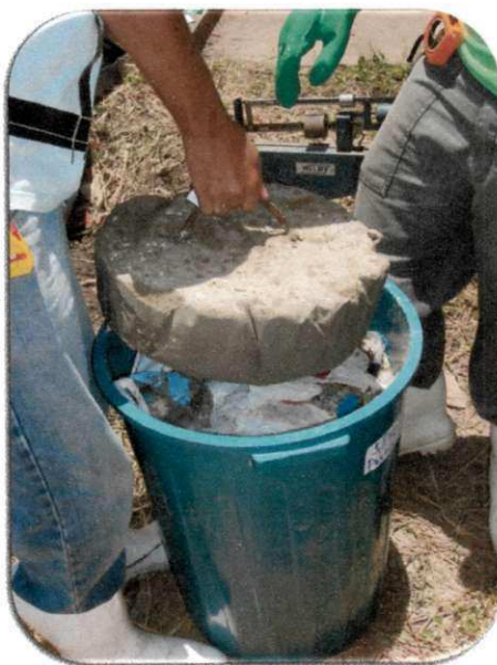
Figura 45 - Soquete em concreto
