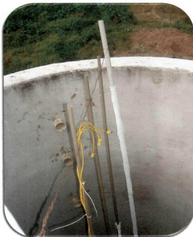
Figura 29 - Disposição da instrumentação geotécnica no lisímetro
