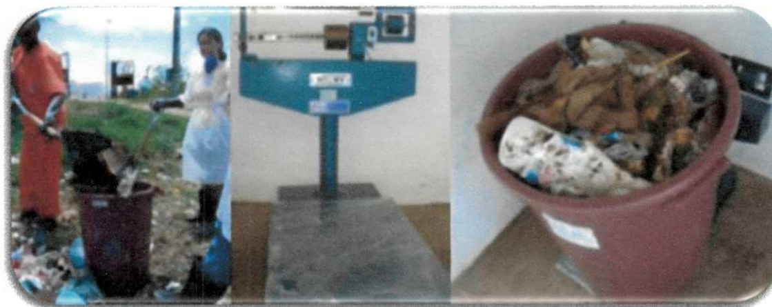
Figura 47 - Determinação da massa específica solta dos resíduos
