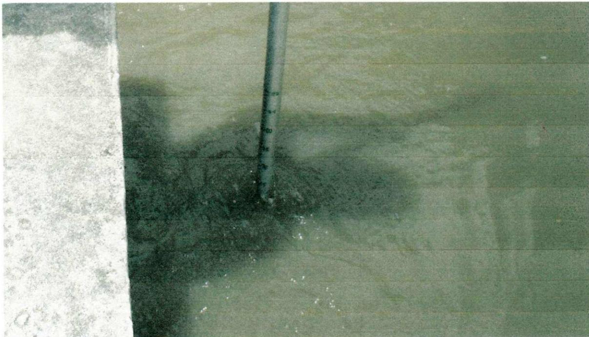
**Figura 3.9** – Leitura da lâmina líquida no desarenador.
