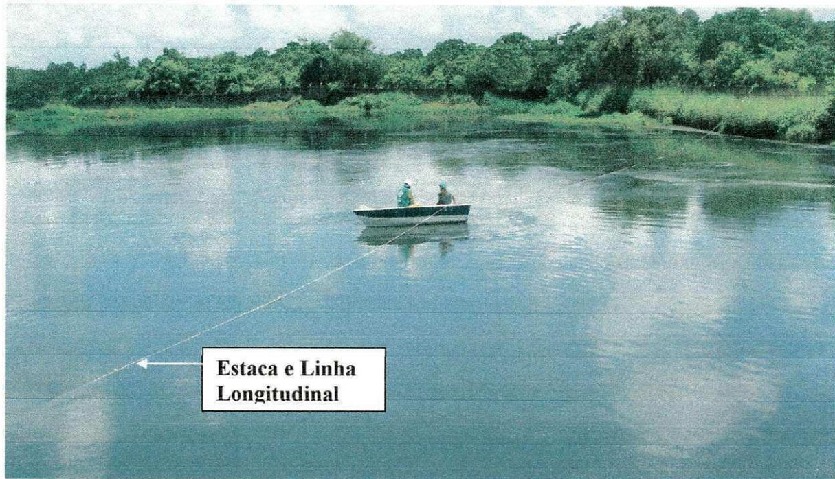
**Figura 3.12** – Linha longitudinal seccionando a lagoa para a realização da batimetria.
