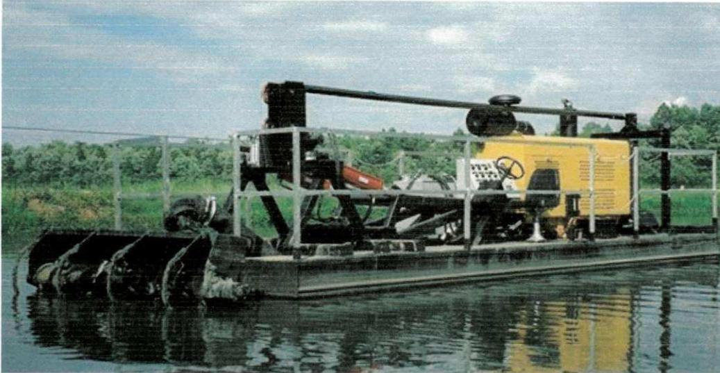
**Figura 2.5** – Draga utilizada na remoção do lodo de lagoas de estabilização
