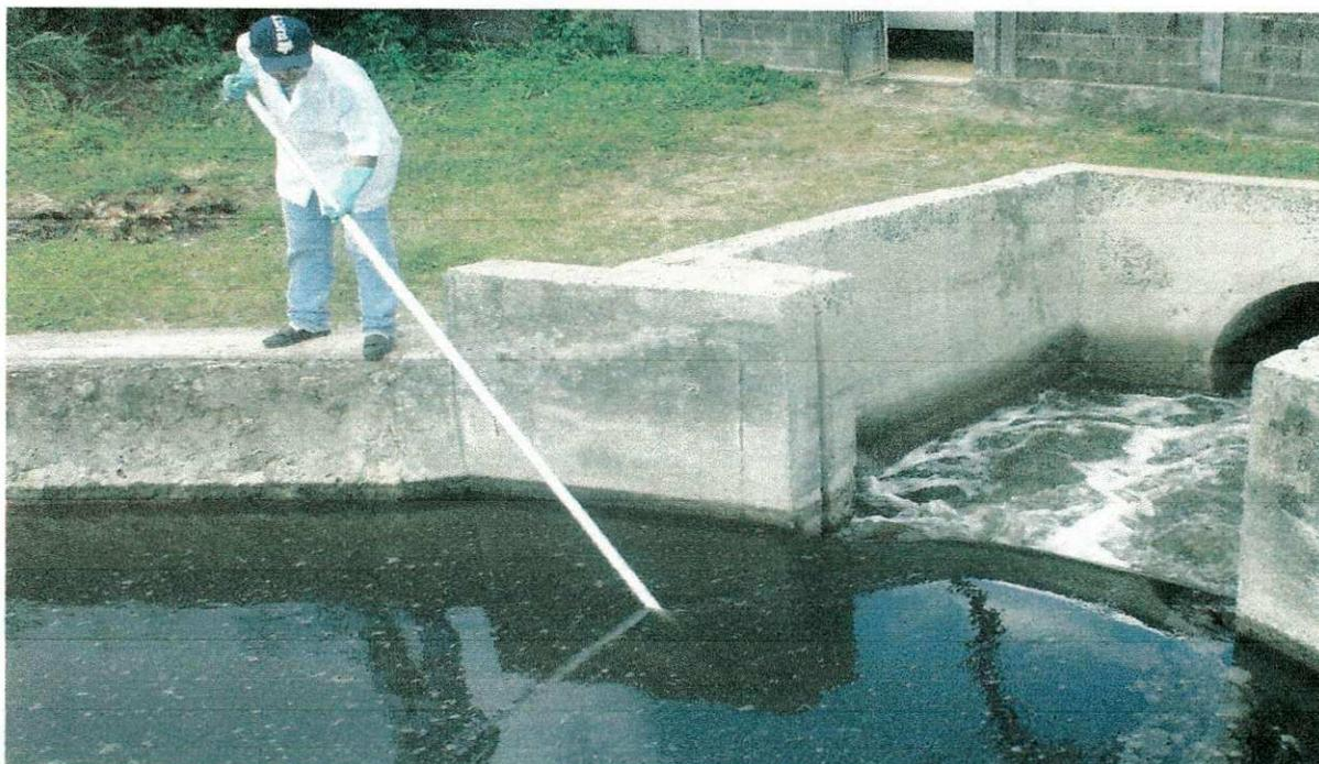
**Figura 3.17** - Coleta de lodo na saída da lagoa anaeróbia profunda (vista do vertedor de saída da lagoa).
