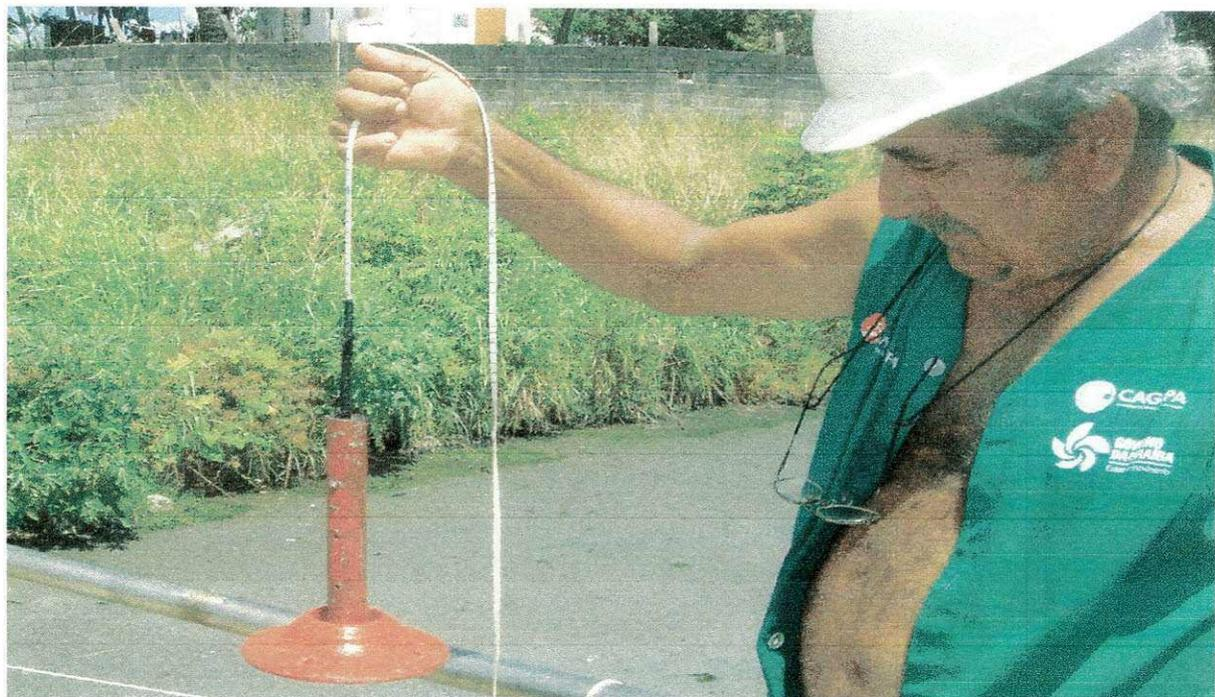
**Figura 3.13** – Disco metálico utilizado na batimetria da lagoa anaeróbia.
