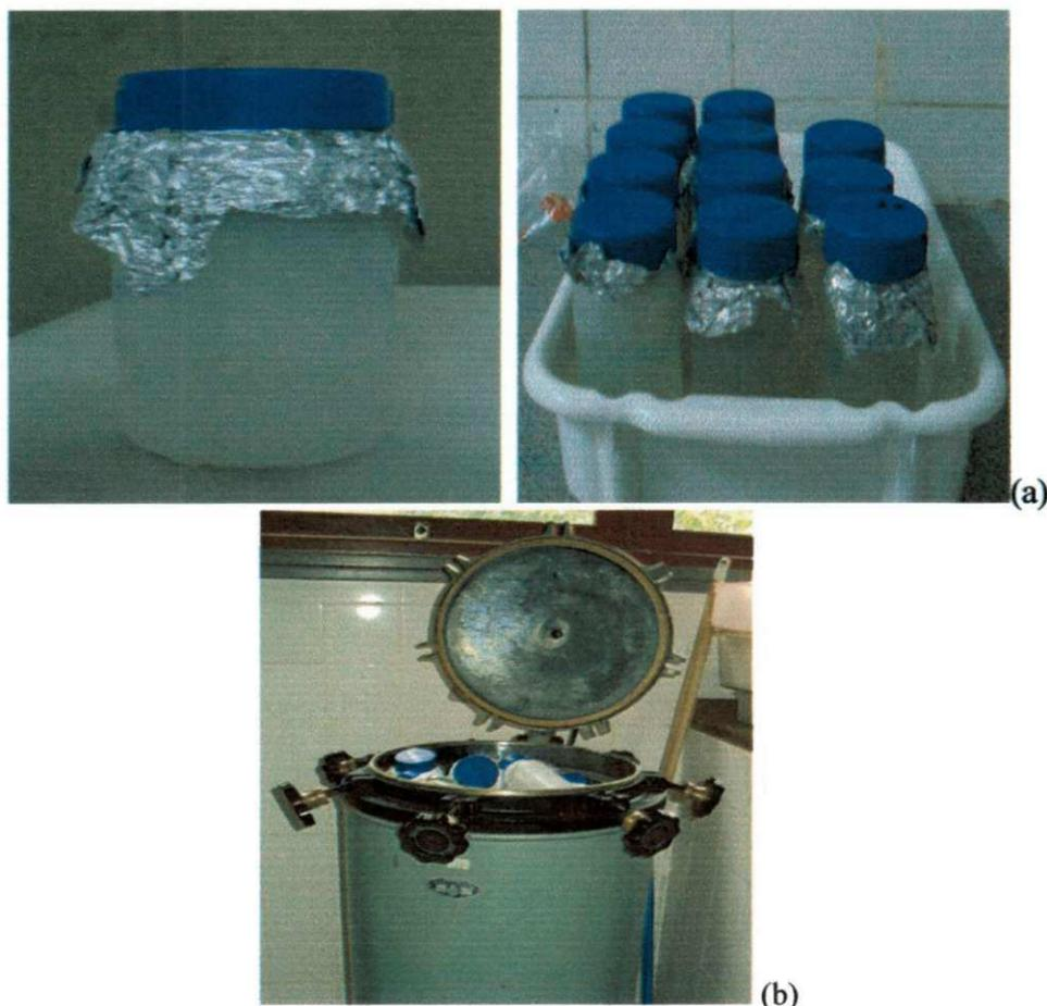
Figura 13 – Garrafas para coleta microbiológica (a), autoclave utilizada na esterilização de recipientes (b).
