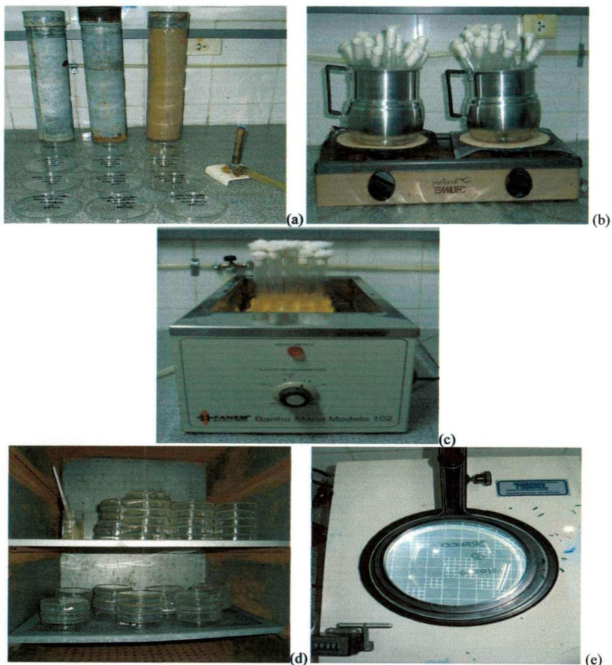
Figura 20 – Procedimento: Bico de Bunsen (a), Tubos de ensaio (b), Meio de cultura em banho-maria (c), Placas na estufa (d), Leitura das placas no contador de colônias (e).
