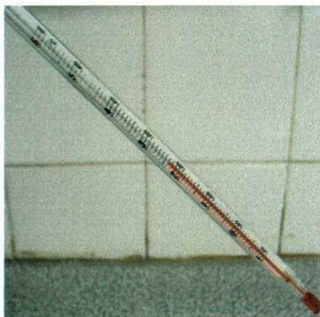
Figura 16 – Termômetro de filamento de mercúrio.
