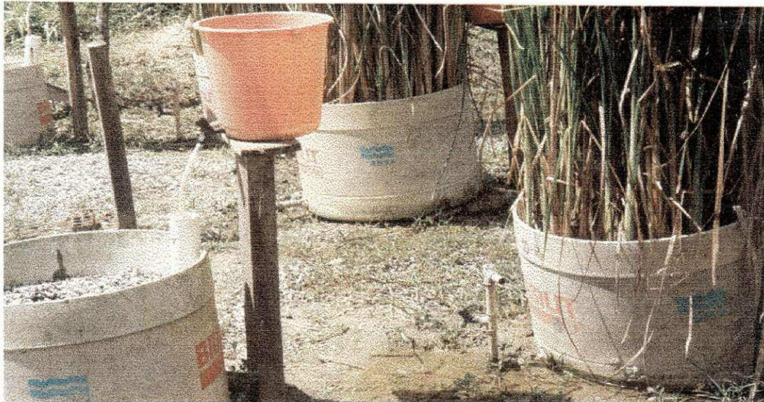
Figura 4.4 – Visualização do sistema de alimentação de um tanque controle do sistema Wetland construído no Campus II da UFPB.
