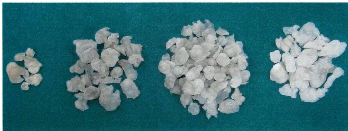
Figura 2.12 - Aparência dos géis coletados na superfície do concreto de uma UHE afetado pela RAS (HASPARYK, 2005)
