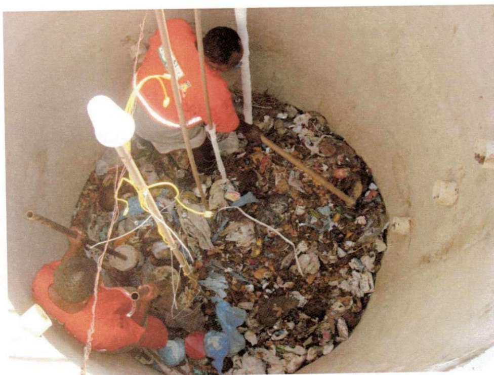
Figura 18 – Resíduo sendo compactado manualmente na célula experimental.
