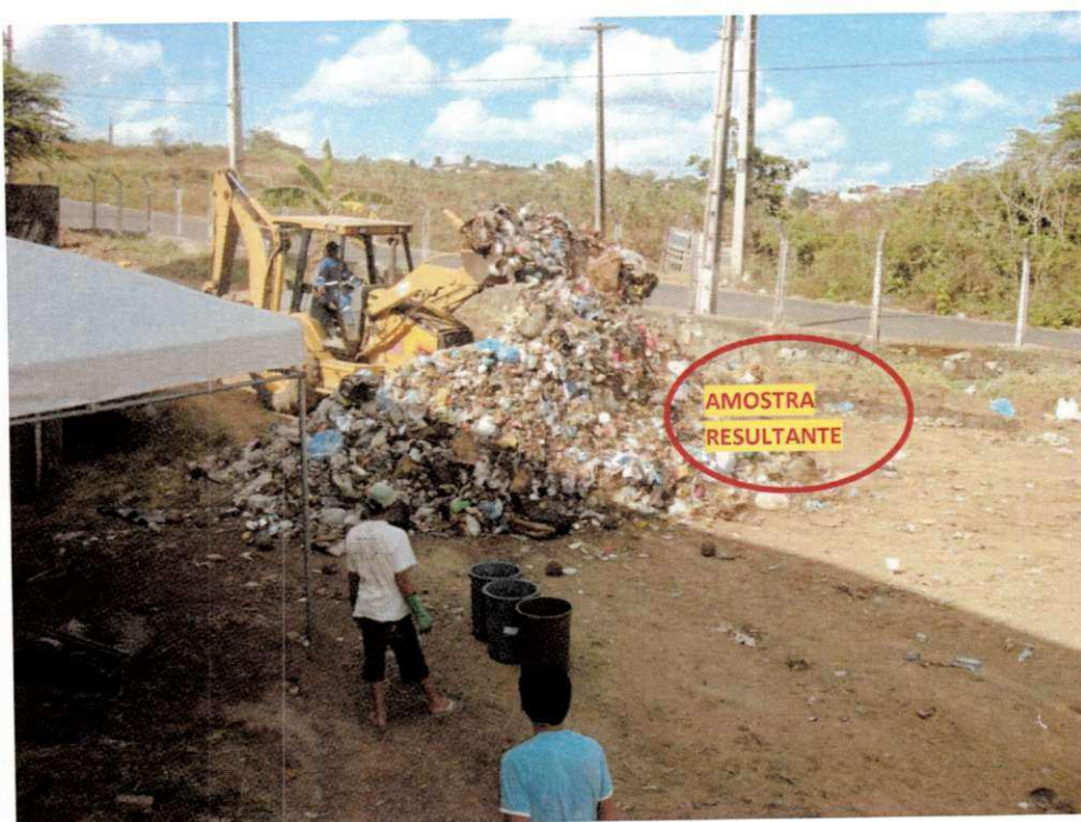
Figura 14 – Amostra de RSU resultante sendo homogeneizada.
