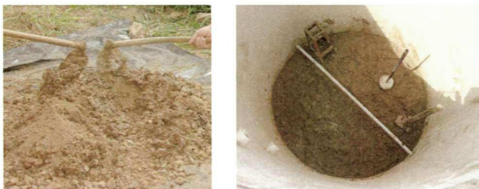
Figura 5 – Solo e camada de base na sua umidade ótima.
