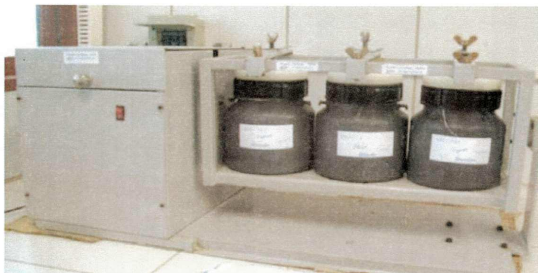
Figura 26 – Agitador rotatório para lixiviação utilizado nesta pesquisa.
