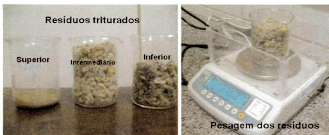
Figura 24 – Amostras sendo processadas para teste de lixiviação.
