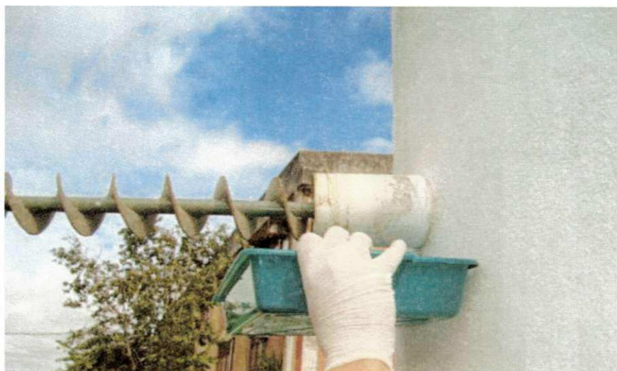
Figura 22 – Coleta dos resíduos através do amostrador confeccionado pelo GGA.
