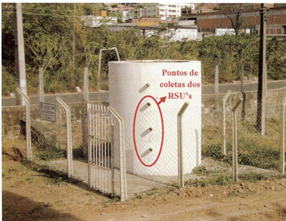
Figura 3 – Lisímetro de RSU localizado na UFCG.
