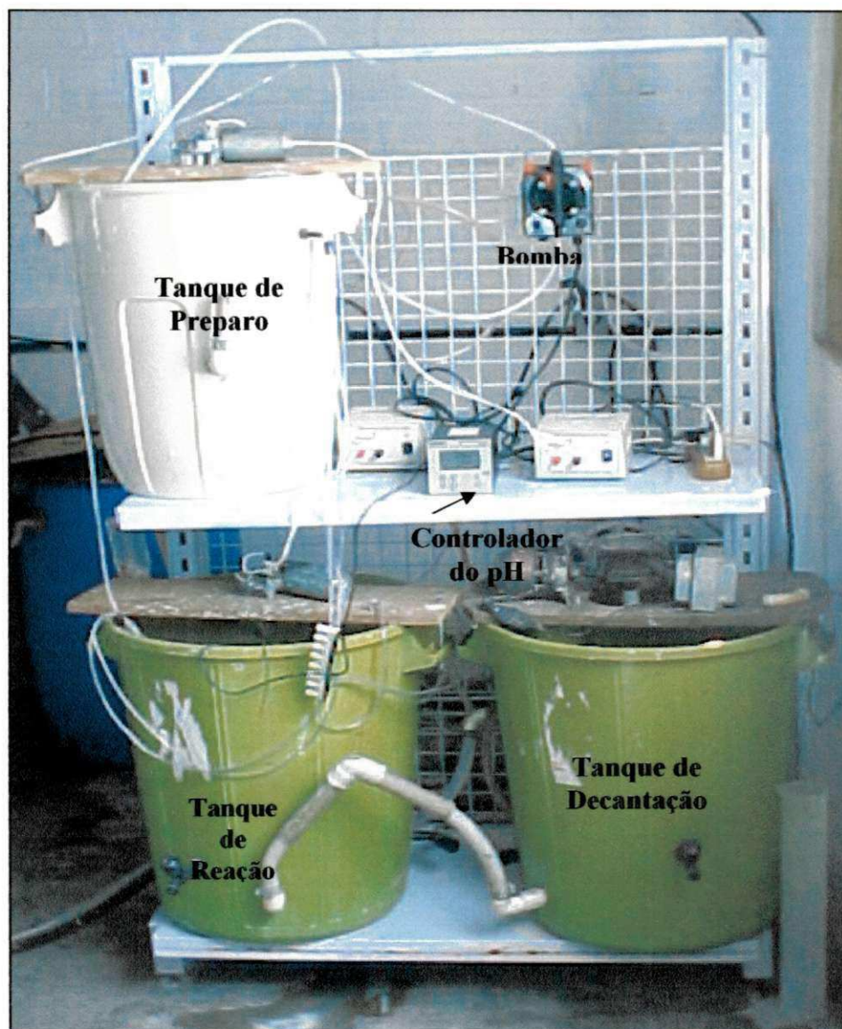
Figura 3.5 – Figura do sistema de pós-tratamento físico-químico, destacando-se o tanque de preparo da suspensão de cal (TP), tanque de reação (TR), tanque de decantação (TD), dispositivos de controle de pH e bomba dosadora.
