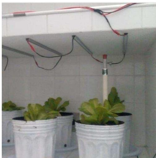
Figura 5. Tensiômetro para controle da tensão de água do solo utilizado em cultivo de alface sob iluminação LED, Campina Grande, PB, 2018.
