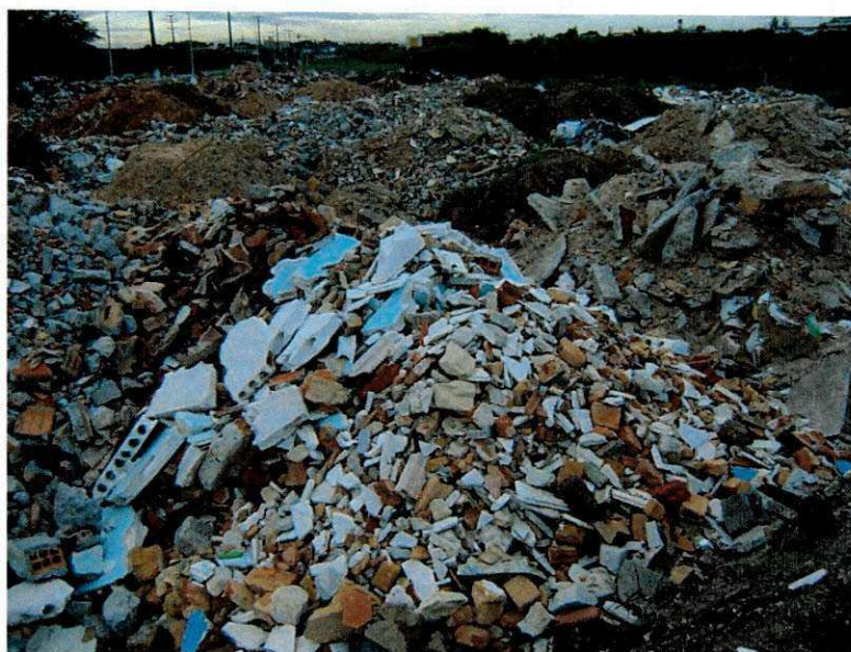
Figura 2.4 – Resíduos de gesso misturados a outros materiais em condições inadequadas em Aracaju (2010).
