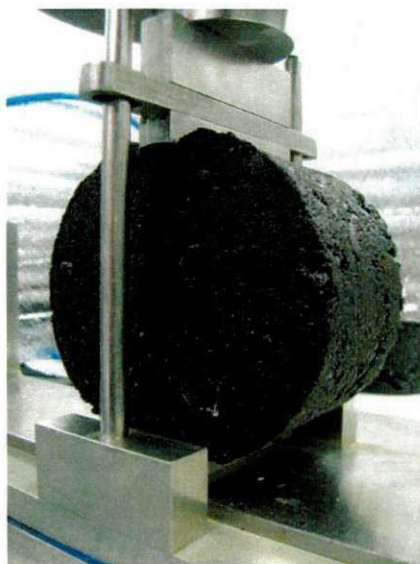
Figura 5.9 – Foto do arranjo do CP durante o ensaio de vida de fadiga por compressão diametral sob tensão controlada.
