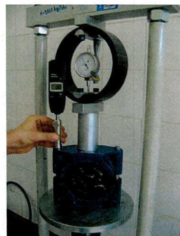
(b) Medida da estabilidade e fluência.
