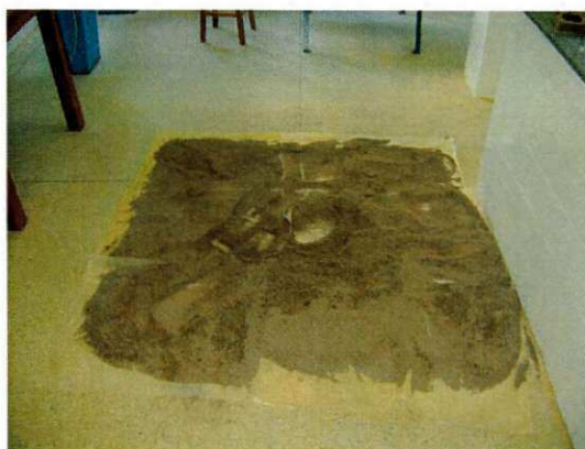
Figura 3.16 – Secagem dos agregados ao ar no GEOPAV.
