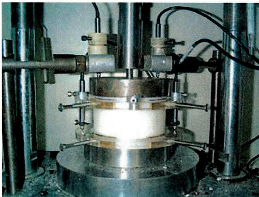
Figura 2.18 – Medida da deformação axial ao longo do corpo-de-prova (adaptado de BERNUCCI et al. , 2006).
