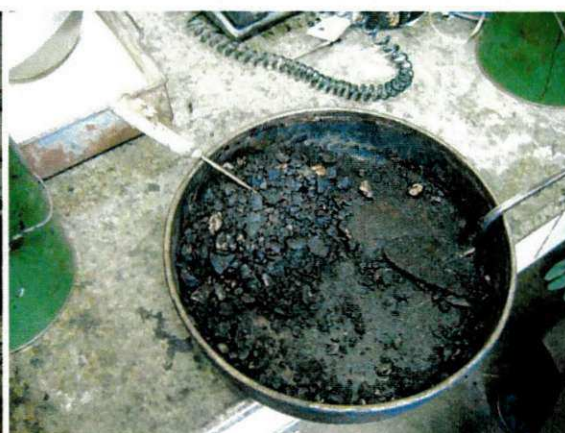
(b) Verificação da temperatura de compactação.
