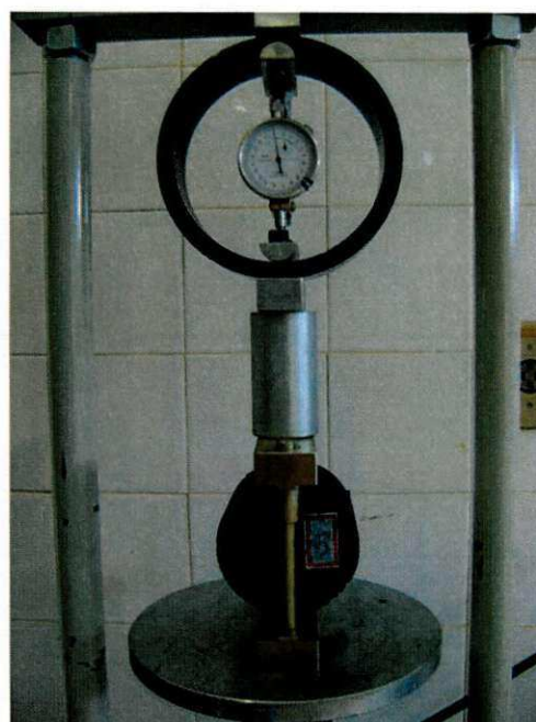
(b) Arranjo do CP durante o ensaio.
