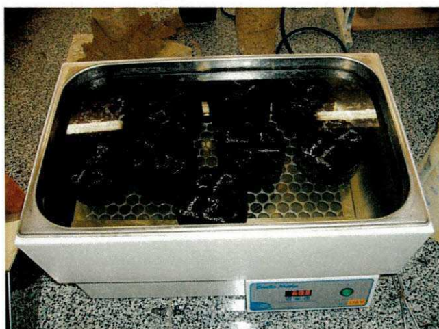
(a) Amostras submetidas a 60 °C por 30 min no banho-maria.
