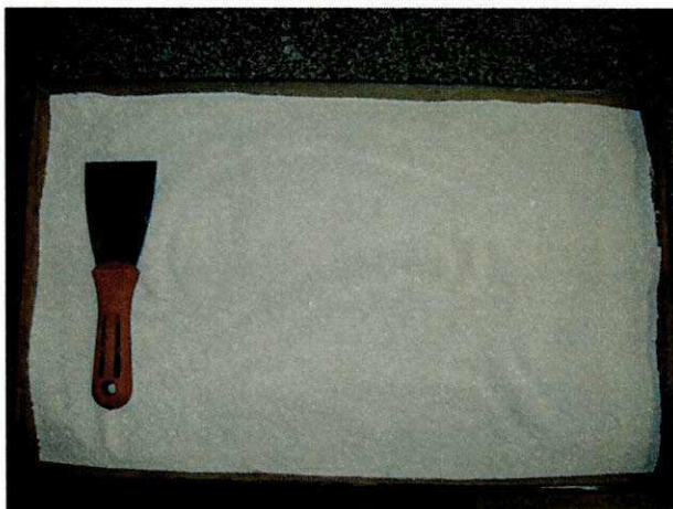
Figura 3.5 – Resíduo de gesso após redução de diâmetro no aparelho de abrasão Los Angeles .
