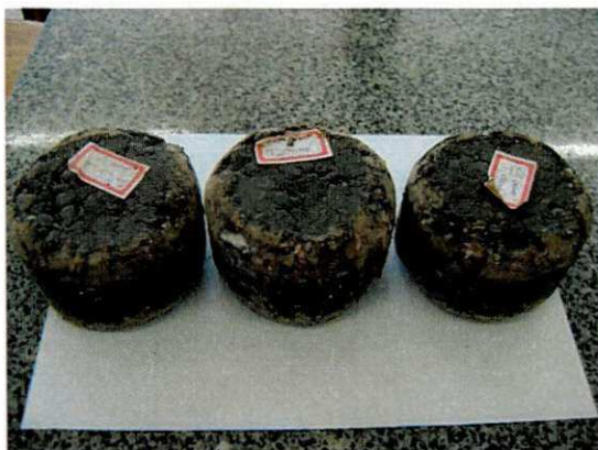
(c) Aspecto das amostras sem gesso após o ensaio.
