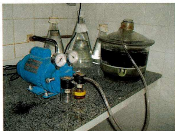
(a) Processo de saturação do CP
