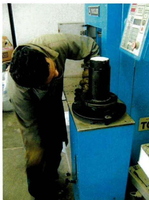
(d) Desmoldagem do CP.
