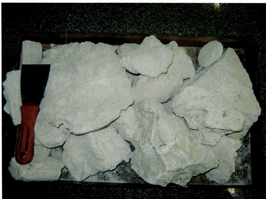
Figura 3.3 – Aspecto do gesso coletado na obra.
