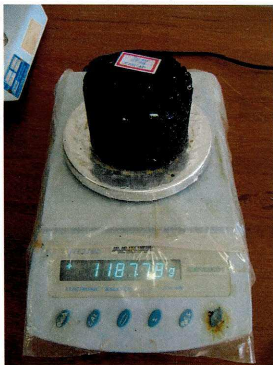
(a) Pesagem do CP antes do desgaste.
