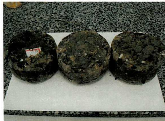
(d) Aspecto das amostras com 2% de gesso após o ensaio.
