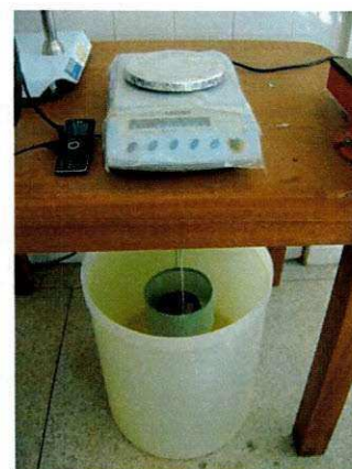
(c) Pesagem dos CPs submersos.
