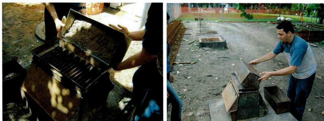
Figura 3.17 – Operação de quarteamento dos agregados para preparação de amostras para os ensaios desta pesquisa.
