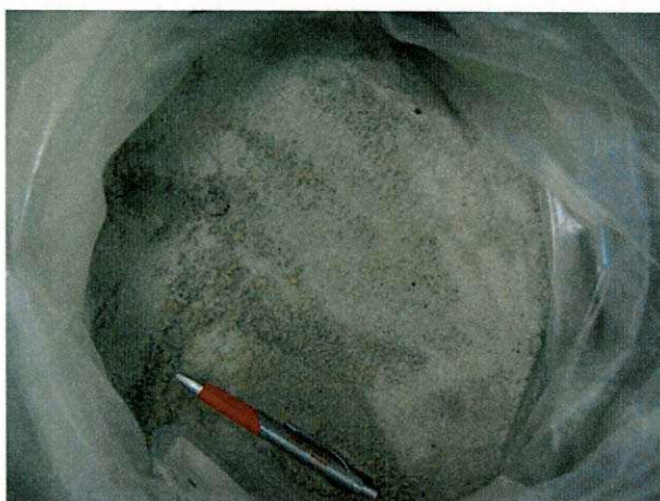
Figura 3.14 – Areia utilizada na mistura do CAUQ da EMURB.
