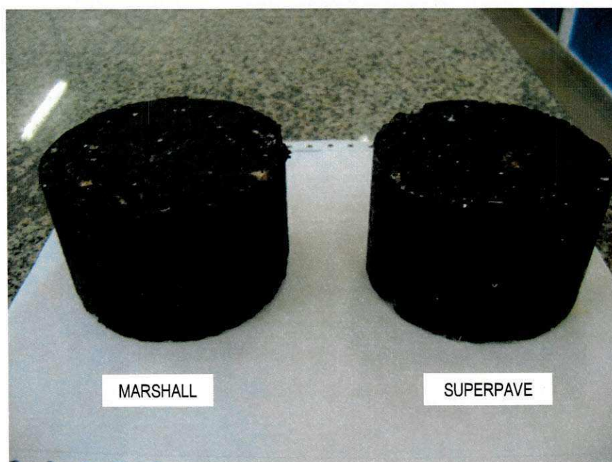
Figura 4.31 – Comparação visual dos corpos-de-prova moldados pela metodologia Marshall e Superpave - Mistura de referência.
