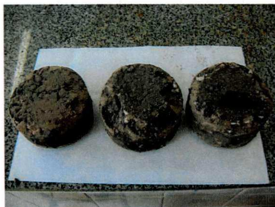
(e) Aspecto das amostras com 4% de gesso após o ensaio – Moldagem Marshall.
