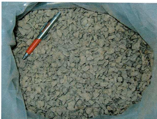
Figura 3.13 – Brita de diâmetro máximo 12,5 mm, utilizada na mistura do CAUQ da EMURB.
