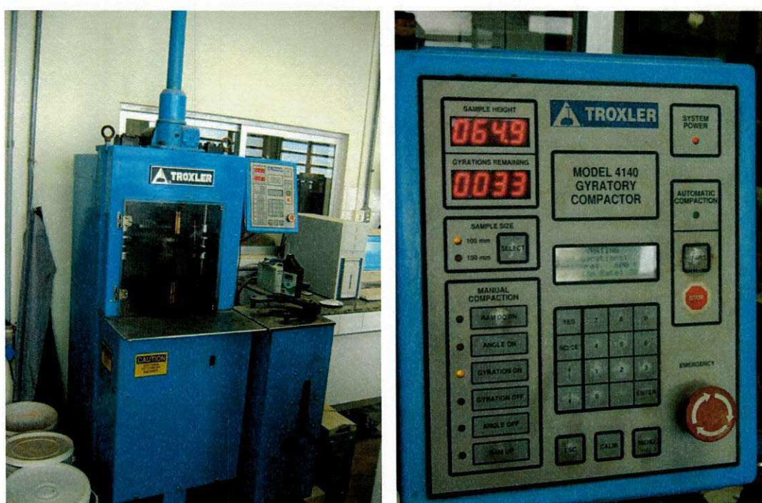
(a) Vista geral do CGS em funcionamento.
