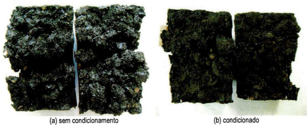
Figura 5.21 – Aspectos do corpo-de-prova com 4% de gesso no ensaio de dano por umidade – moldagem Marshall.
