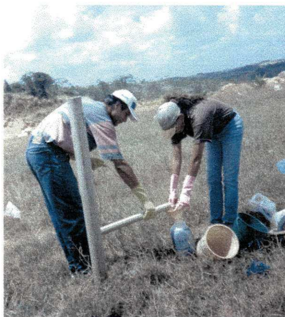
Figura 2.8 – Coletor tipo caneca utilizado para coleta de chorume no interior dos piezômetros no Aterro da Muribeca – Jaboatão dos Guararapes (PE)
