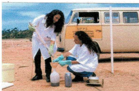
Figura 2.15 – Coleta do chorume de um piezômetro instalado no Aterro da Muribeca – Jaboatão dos Guararapes (PE) utilizando o coletor tipo “caneca”.
