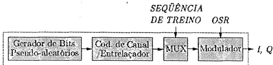
Figura 3.3: Estrutura do transmissor. Os parâmetros *SEQUÊNCIA DE TREINO*, *OSR*, *I* e *Q* de entrada e saída são usados na implementação.
