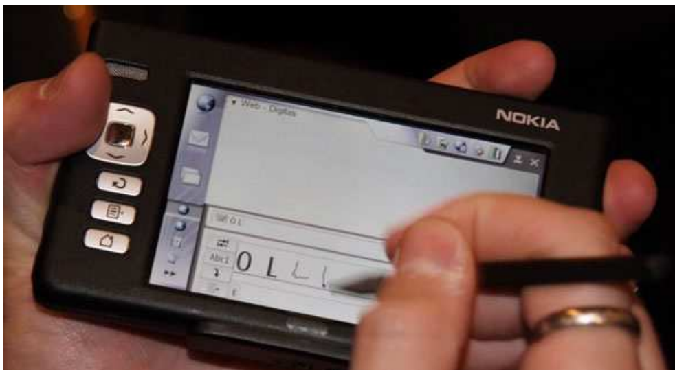
Figura 15 – Reconhecimento de escrita - Nokia 770 Internet Tablet. Fonte: (Nokia, 2005a) © Copyright 2005. Nokia. Todos os direitos reservados.
