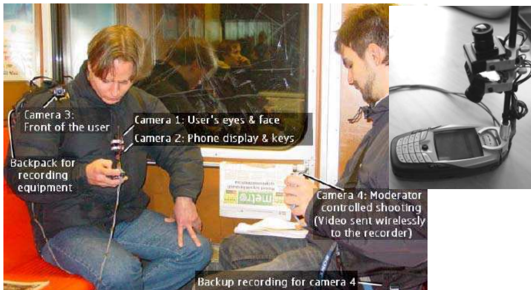
Figura 19 – Equipamentos para condução de testes em campo. No detalhe, micro-câmeras acopladas ao dispositivo móvel.
