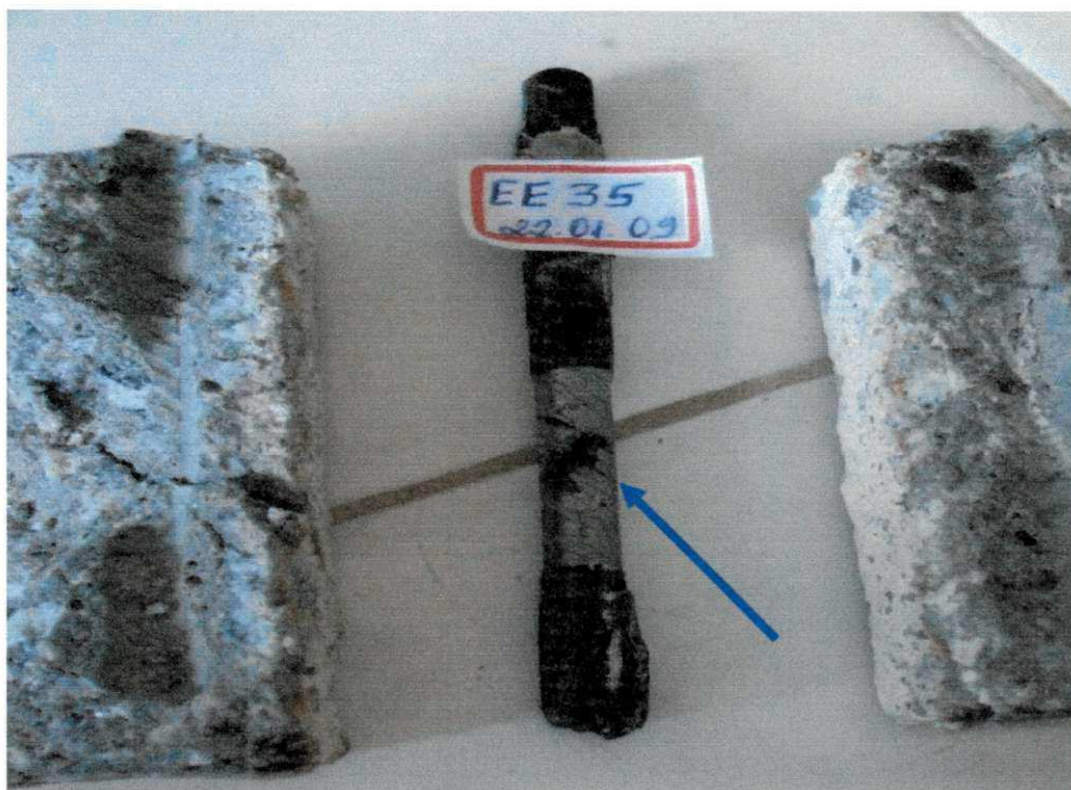
Figura 43 – Corpo de prova do concreto 0,5 em solução de 1M NaCl + 2% H 2 SO 4
