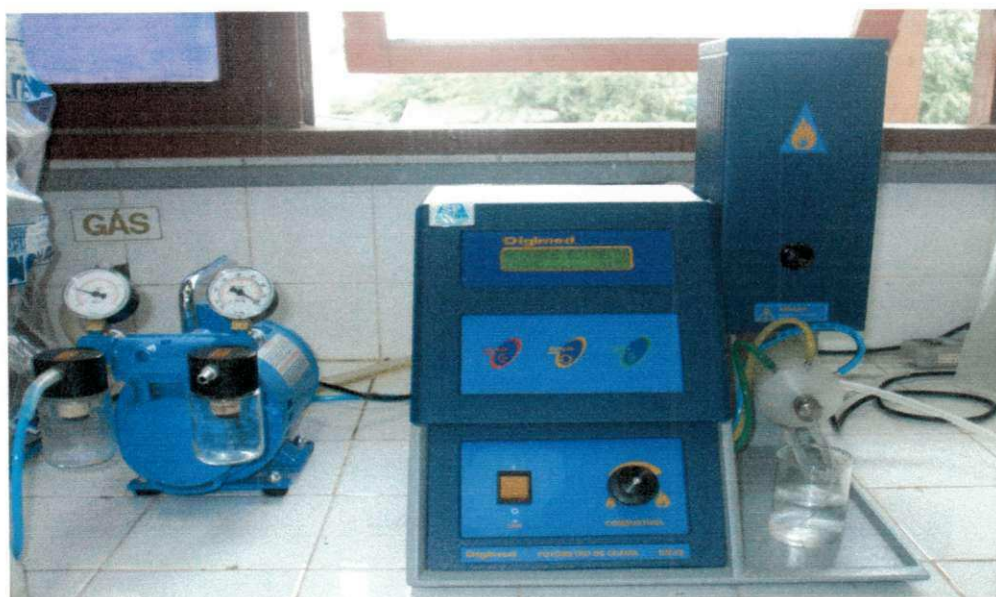
Figura 19 - Fotômetro de chama
