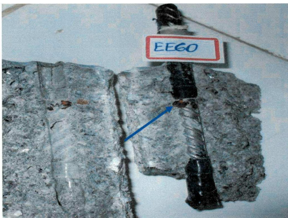
Figura 44 – Corpo de prova do concreto 0,6 em solução de 1M NaCl + 2% H 2 SO 4
