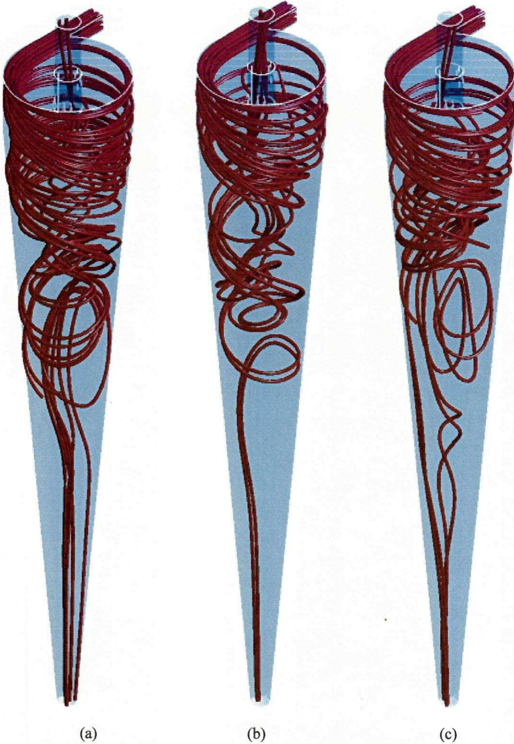
Figura 4.5: Linhas de fluxo do óleo para diferentes diâmetros da gota, viscosidade média constante e velocidade de alimentação de 30 m/s: (a) 1 \times 10^{-4} \text{ m} ; (b) 1 \times 10^{-5} \text{ m} ; (c) 1 \times 10^{-6} \text{ m} .
