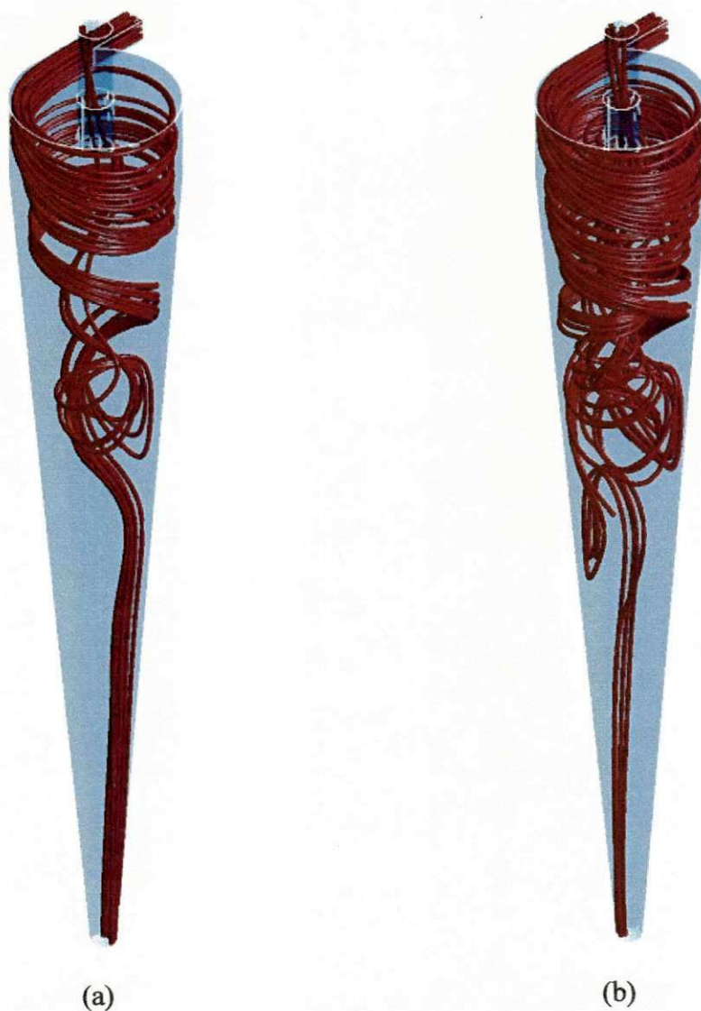
Figura 4.7: Linhas de Fluxo do óleo para diferentes velocidades de entrada e o diâmetro da gota 1 \times 10^{-3} \text{m} : (a) 20 m/s (b) 30 m/s.
