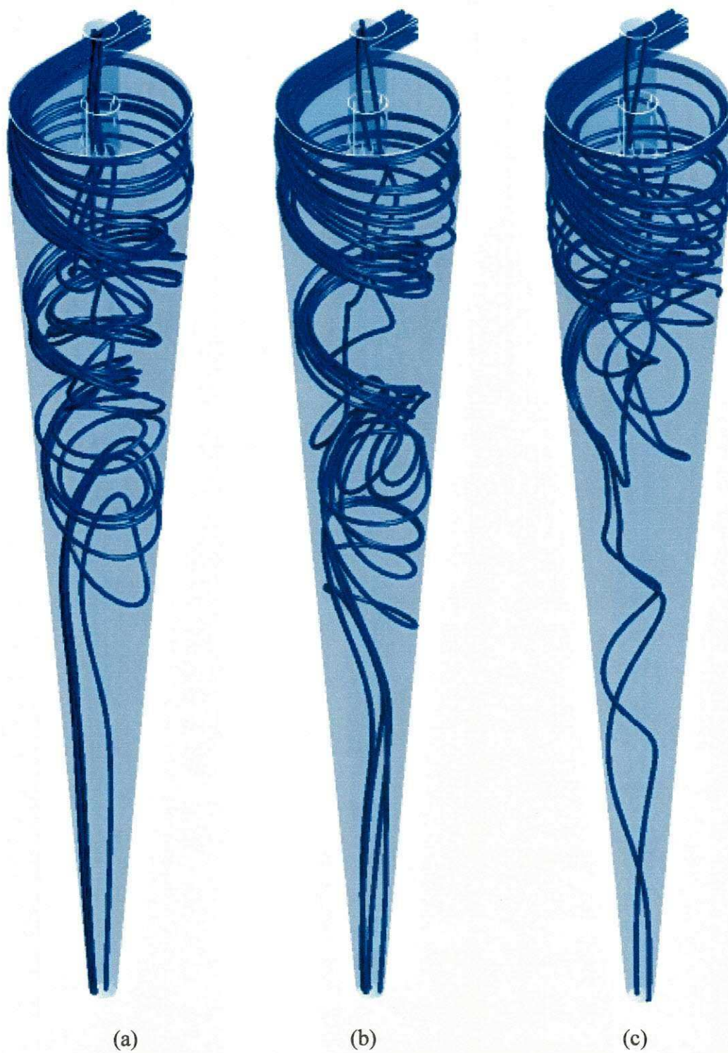
(a) (b) (c) Figura 4.4: Linhas de Fluxo da água para diferentes diâmetros da gota, viscosidade em função da temperatura e velocidade de entrada de 30 m/s: (a) 1 \times 10^{-4} \text{ m} ; (b) 1 \times 10^{-5} \text{ m} ; (c) 1 \times 10^{-6} \text{ m} .
