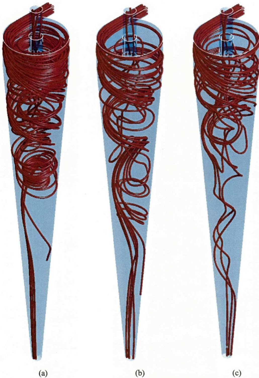
Figura 4.3: Linhas de Fluxo do óleo pesado para diferentes diâmetros da gota, viscosidade em função da temperatura e velocidade de entrada de 30 m/s:
