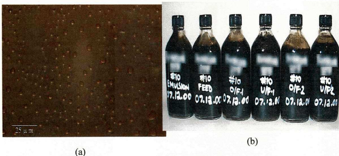
(a) (b) Figura 2.25: Ilustração de uma micrografia de (a) gotas de óleo de 4 \mu\text{m} e (b) o resultado da separação das mesmas Fonte: Hashmi et al. (2004).
