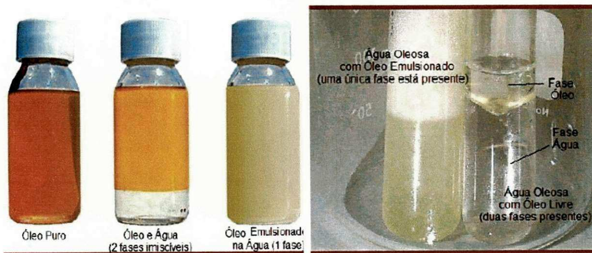
Figura 2.5: Diferentes fases na mistura água/óleo. Disponíveis em: www.engenovo.com.br/pt/artigostecnicos/taoind , acesso em setembro de 2009.
