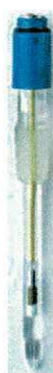
Figura 14: Eletrodo de referência de Hg|HgO utilizada nas determinações do coeficiente de transferência de massa ( D_A ) e a concentração real dos íons ferricianetos de potássio no seio da solução ( C_{A\infty} ).
