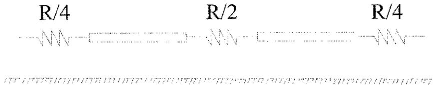
Figura 3.2 – Linha de transmissão com perdas concentradas nas extremidades
