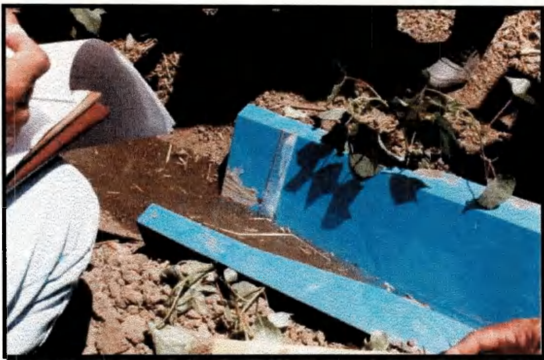
FIGURA 3. Ilustração da determinação da vazão, através da calha WSC modelo FEX 1-34
