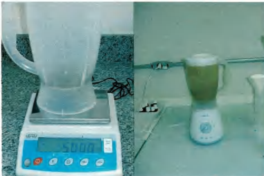
Trituração dos grãos; peneirando-os com granulometria de 14 mesh; pesando o triturado (50,00 g); início do processo de extração de aflatoxinas (50 g do triturado adicionados de 30 mL de solução aquosa a 4% (m/v) de KCl e 270 mL de metanol)
