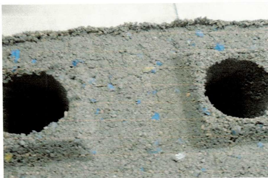
Figura 57: Detalhe da rachadura do tijolo desmoldado traço 1:3 (cimento : 80% SBR + 20% areia)
