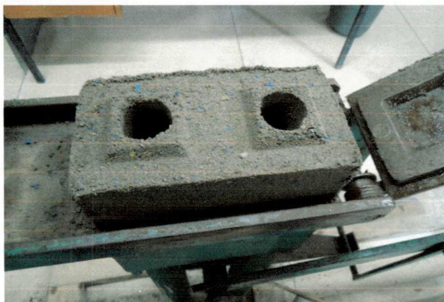
Figura 56: Vista em perspectiva do tijolo desmoldado traço 1:3 (cimento : 80%
