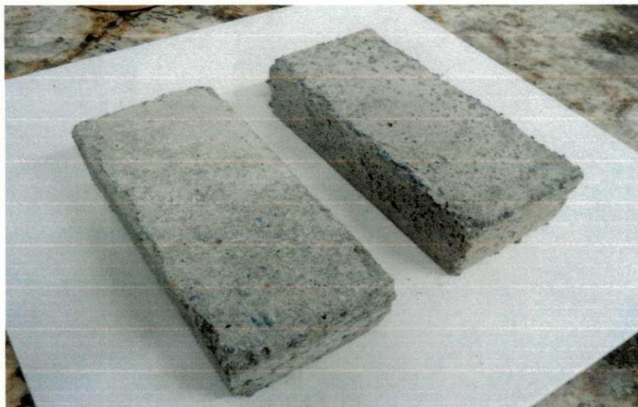
Figura 59: Tijolos retirados da forma de descanso após 48 horas
