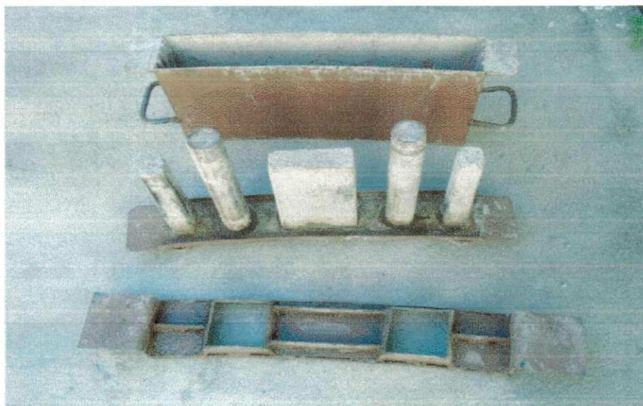
Figura 50: Forma para confecção de tijolos – procedimento batidas ao chão
