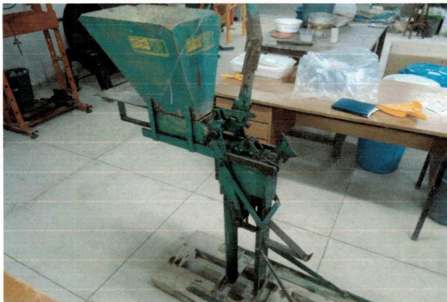
Figura 53: Máquina manual de confecção de tijolo de solo/cimento
