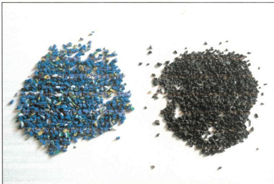
Figura 23: Decomposição térmica do resíduo acima de 300°C
