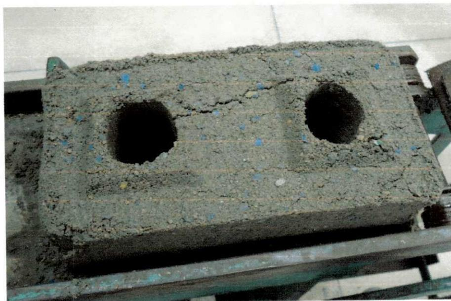
Figura 58: Detalhe da rachadura do tijolo durante a tentativa de retirada da forma traço 1:3 (cimento : 80% SBR + 20% areia)
