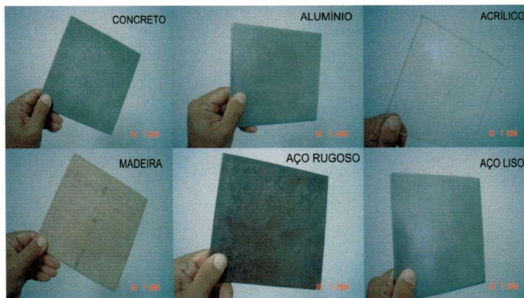
Figura 10 – material utilizado nos ensaios de parede
