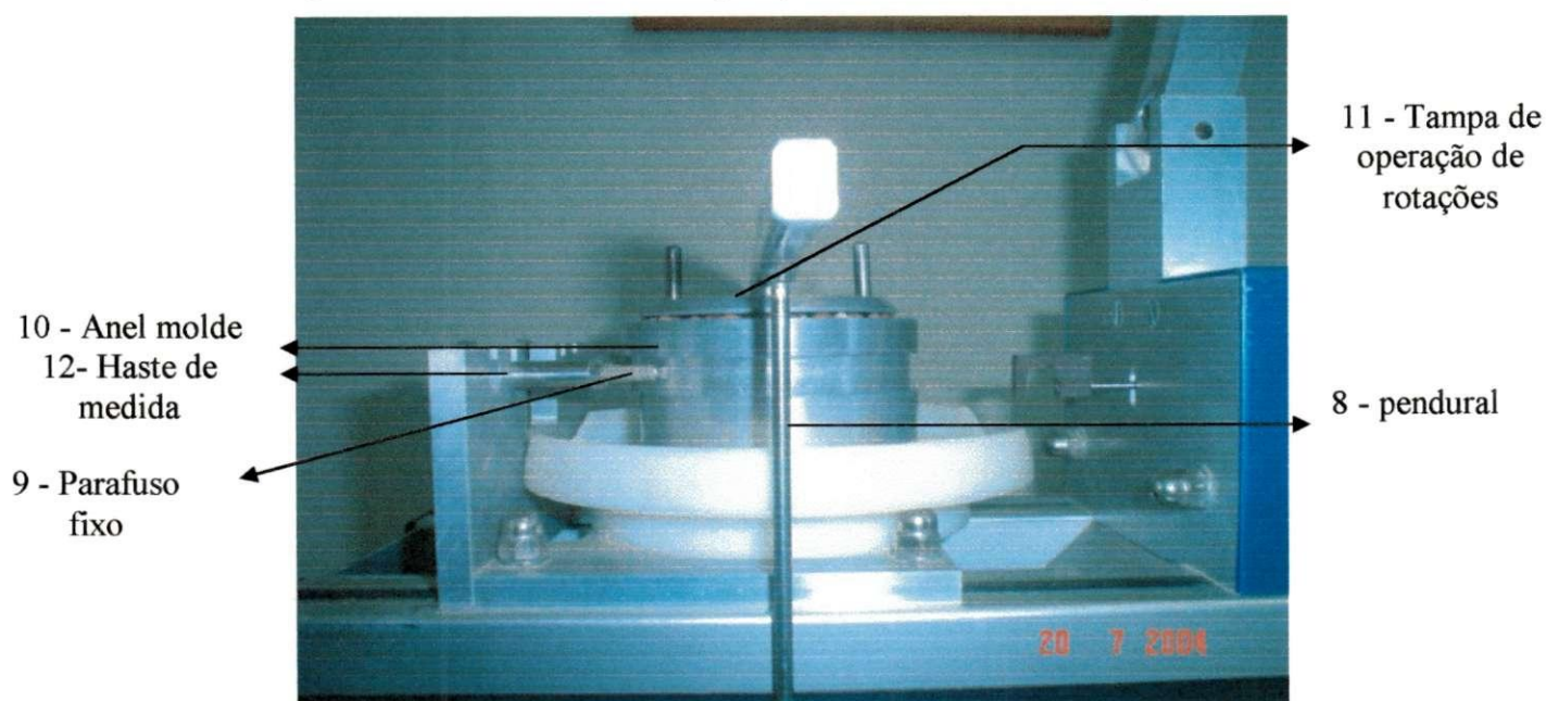
Figura 05 - Célula de cisalhamento com anel molde e tampa de consolidação
