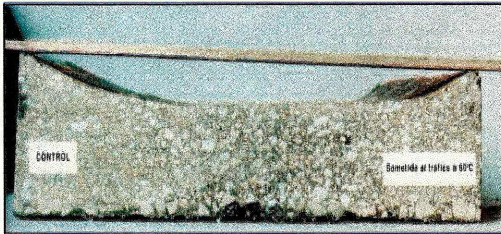
Figura E1: Resultados de ensaio de trilha de rodas em misturas com asfalto convencional, submetida ao tráfego a 60°C (Revista RUTAS Nº 63, 1997, p. 33-39)
