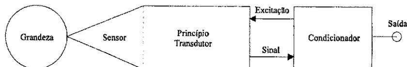
Figura 2.4: Relação entre grandeza, transdutor e condicionamento.
