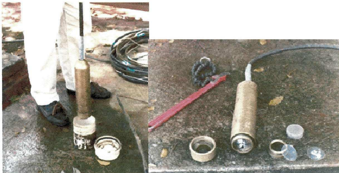
Foto 3.8: Fonte do tipo explosiva utilizada para Identificação das ondas de compressão “P”.
