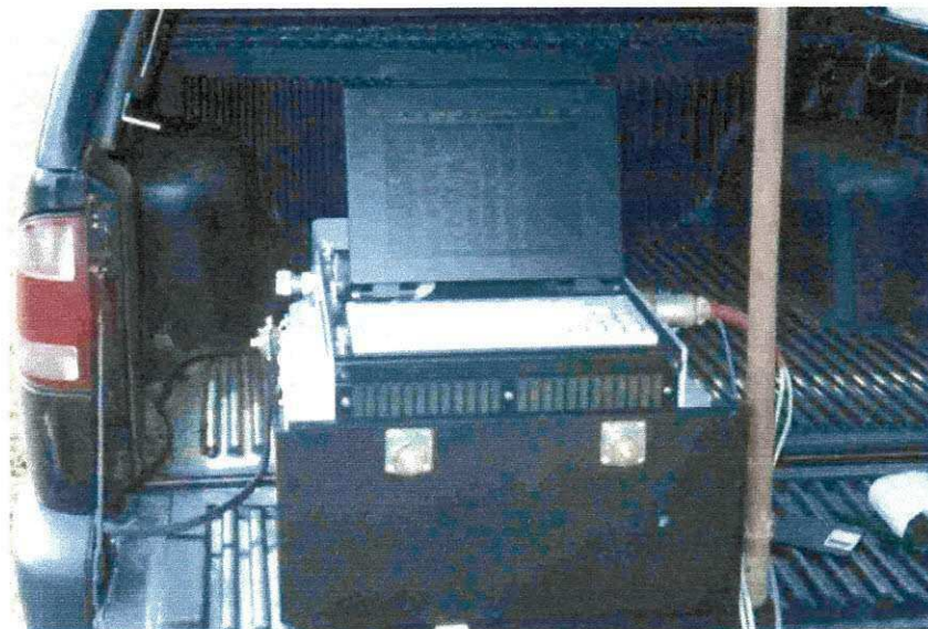
Foto 3.9: Sismógrafo digital de 24 canais, modelo DAS-1 de fabricação OHYO GEOSPACE
