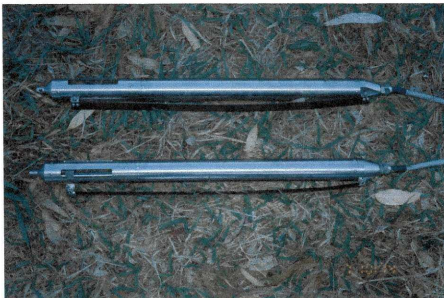
Foto 3.4: Geofones Triaxiais modelo DHTG de fabricação GISCO.
