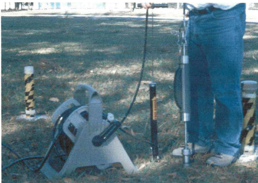
Foto 3.6: Fonte sísmica tipo martelo sísmico, modelo DHSW de fabricação GISCO. INC.
