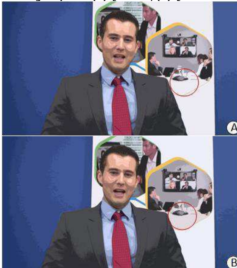
Figura 44 - Cintilação provocada pela mudança de nível de quantização de alguns pixels: (A) Quadro 1; (B) Quadro 2.
