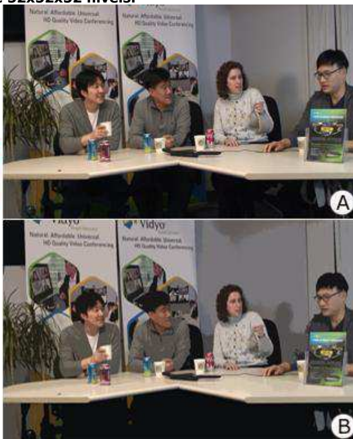
Figura 36 - Ilustração das possíveis cores no sistema RGB fatiado em cubos de 52x52x52 níveis de cinza: (A) Quadro original; (B) Quadro Quantizado com cubos de 52x52x52 níveis.
