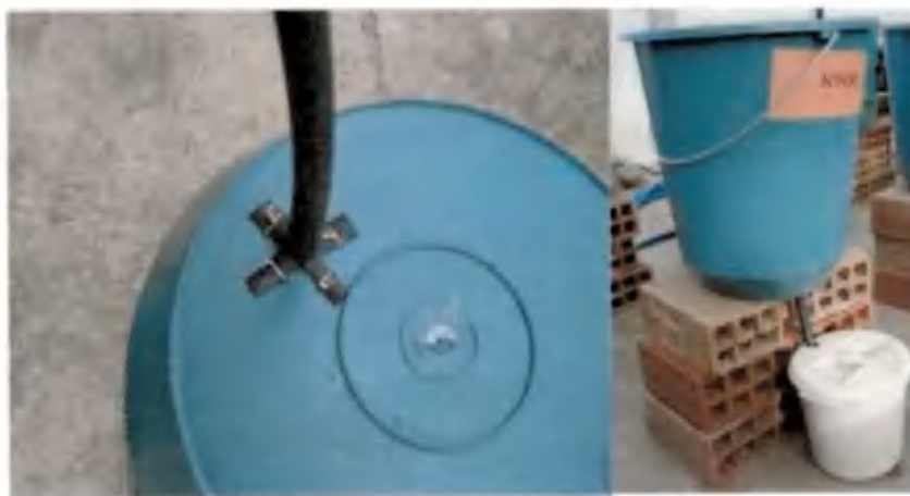
Figura 5. Sistema de drenagem utilizado no experimento
