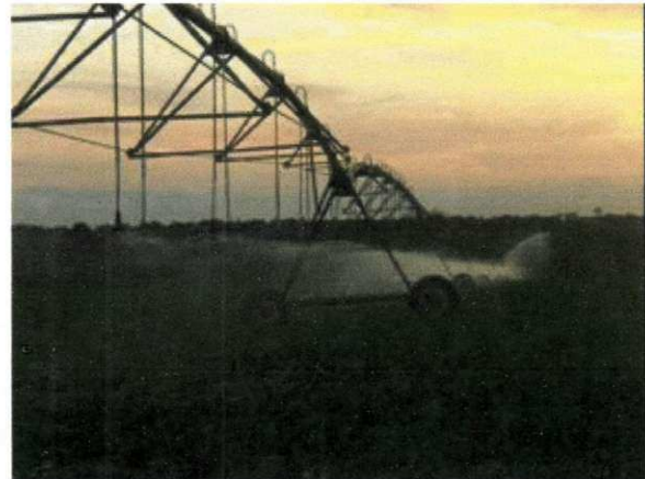
Figura 1.4. Irrigação por aspersão, tipo pivô central rebocável, em cana-de-açúcar. (Fotos: Pivô central rebocável na destilaria Miriri S.A. Carlos Henrique de A. Farias)
