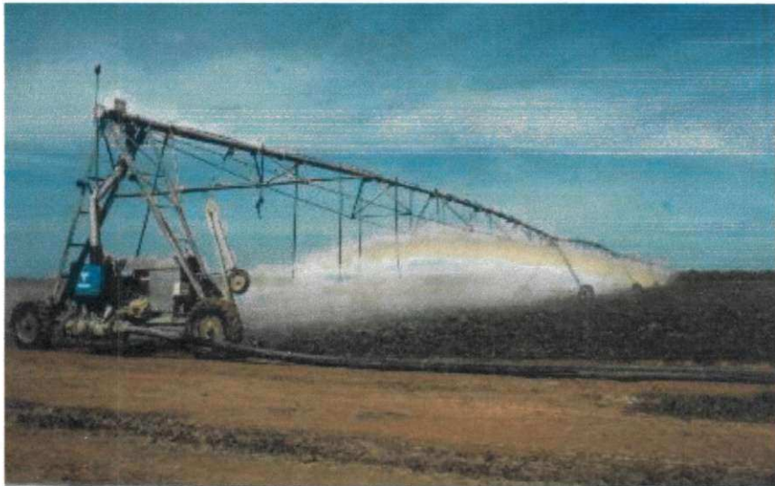
Figura 1.5. Irrigação por aspersão, tipo pivô linear, em cana-de-açúcar.
