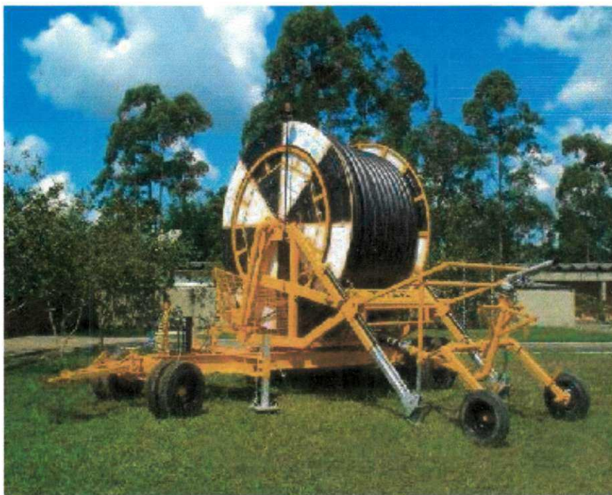
Figura 1.6. Irrigação por aspersão, autopropelido, em cana-de-açúcar.
