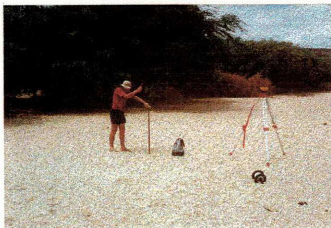
Figura 18 : Leitura do nível da água a cada 100 metros com poço-ponteira
