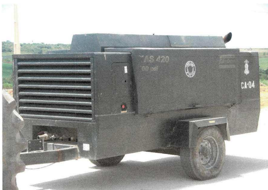
Figura 2.26 – Compressor de ar para remoção de partículas sólidas.
