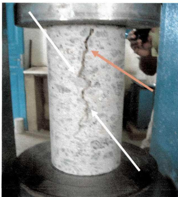
Figuras 3.7 – Corpo de prova extraído após injeção de calda coloidal de microcimento.
