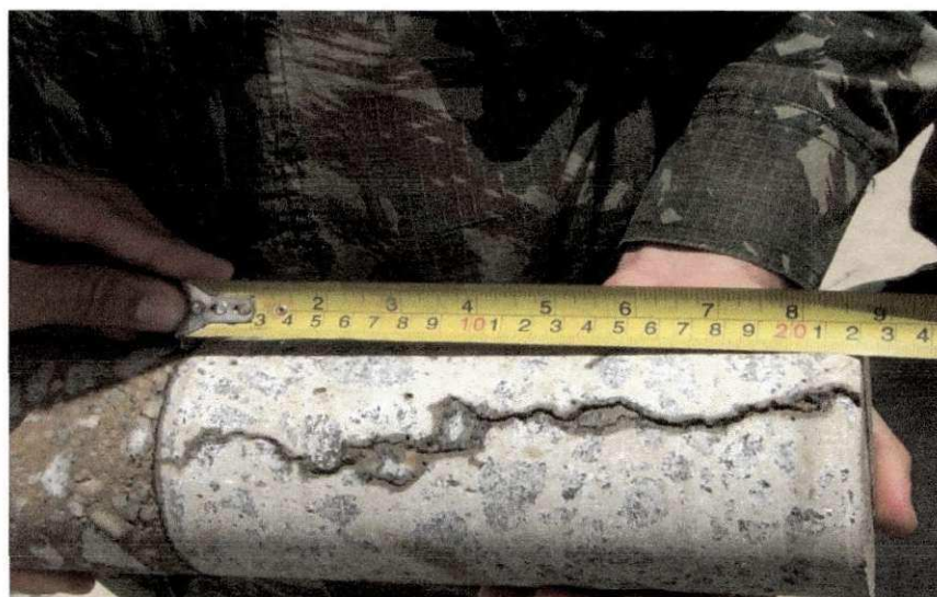
Figura 3.6 – Corpo de prova extraído sem injeção de calda coloidal de microcimento.
