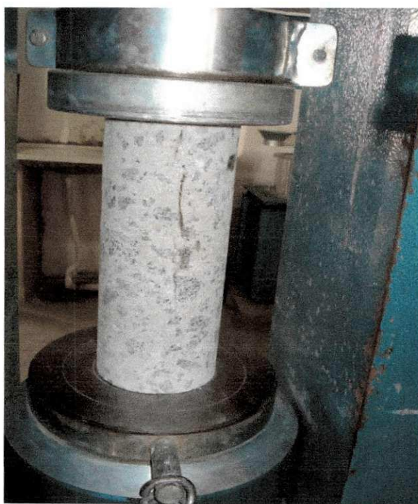
Figura 3.9 – Corpo de prova submetido à compressão axial.
