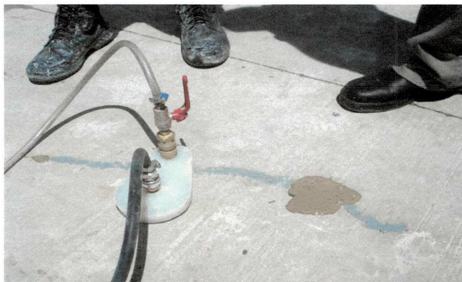
Figura 2.14 - Obturador a vácuo.
