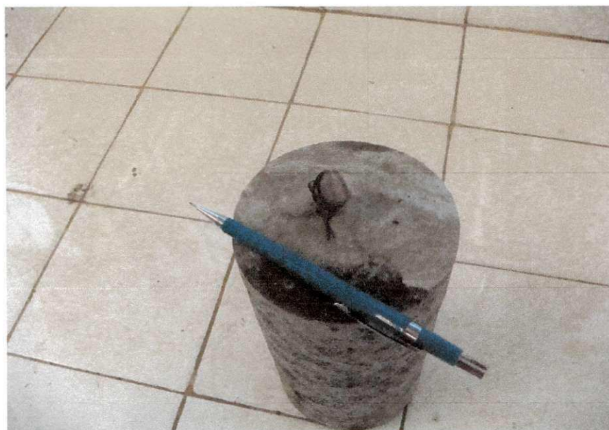
Figura 2.13 - Corpo de prova extraído do pavimento após a aplicação da resina epóxídica
