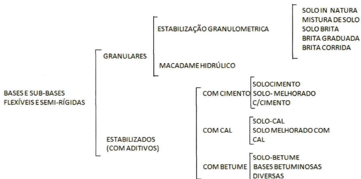
Figura 2.1 – Tipos de bases e sub-bases flexíveis e semi-rígidas. Fonte: DNIT (2006)
