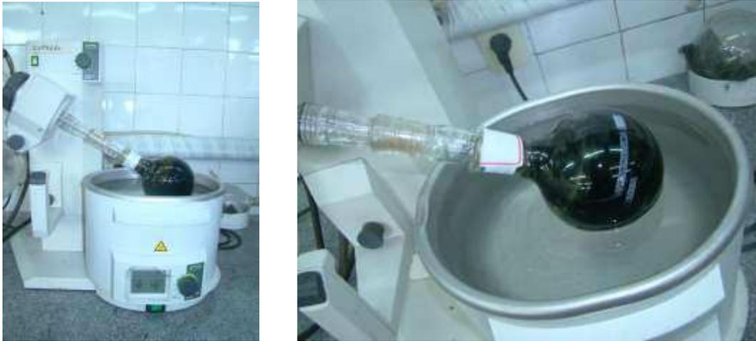
Figura 9 – Rota evaporador rotatório R-210 BUCHI (Autor, 2016).
