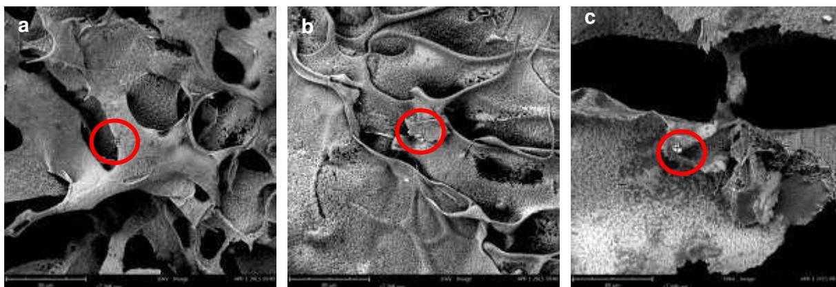
Figura 53 – Micrografia eletrônica de varredura do SQ20 neutralizado com  $\text{NH}_4\text{OH}$ . Ponto 1 (em vermelho) e ponto 2 evidenciados nas superfícies em contato com o ar (a), superfície em contato com a placa (b), e na superfície de corte transversal (c). Aumento 1000x (Autor, 2016).
