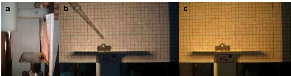
Figura 20 – Análise de molhabilidade dos *scaffolds* de quitosana: amostra no suporte (a), gotejamento da água destilada (b), obtenção da fotografia da gota (c) (Autor, 2016).
