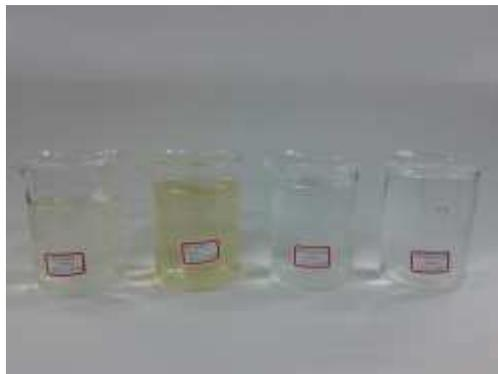
Figura 25 – Aspecto das soluções de hidróxido de amônio após o processo de neutralização (Autor, 2016).
