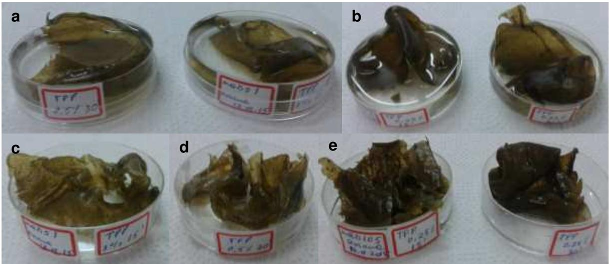
Figura 33 – Amostras de filmes de quitosana/droga vegetal em contato com o TPP na concentração de 0,5% e 1% (a) e nas concentrações de 0,25% por 15 e 30 minutos (b). Após processo de reticulação, evidencia-se o aspecto das amostras com 1% (c), 0,5% (d) e 0,25% (e) (Autor, 2016).
