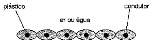
**Figura 5-13: Seção transversal do cabo flexível**
