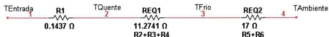
Figura 44: Circuito equivalente ao sensor de velocidade do vento
