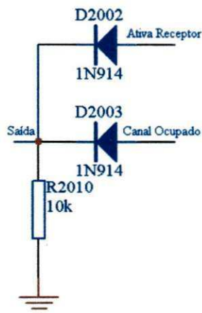
Figura 26: Função lógica que determina a presença de dados no receptor
