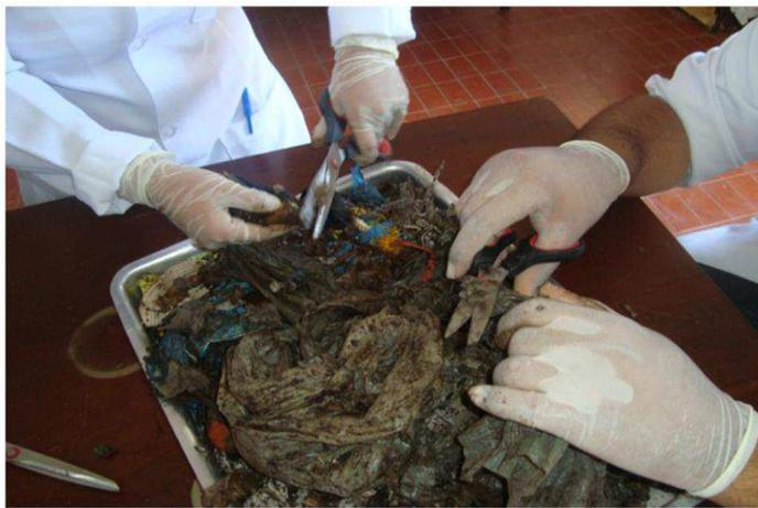
Figura 17 - Picotagem dos RSU coletados na célula experimental
