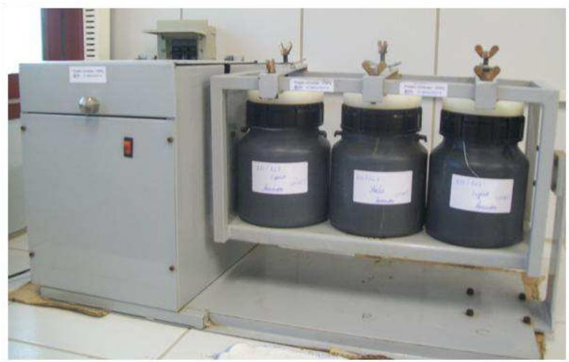
Figura 18 – Agitador rotatório para testes de lixiviação
