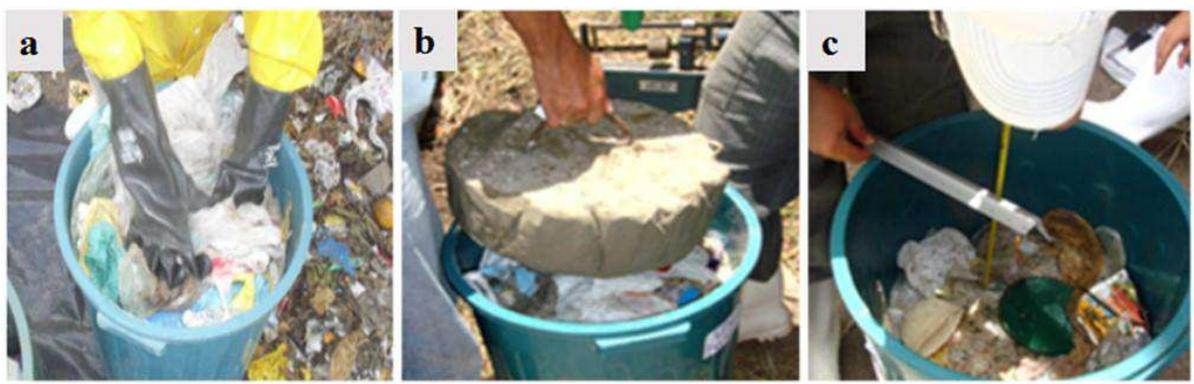
Figura 15 - (a) Composição Volumétrica dos RSU; (b) Compactação dos resíduos sólidos; (c) Medição do diâmetro e altura dos resíduos sólidos
