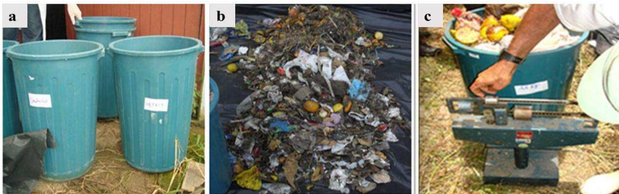
Figura 13 - Composição Gravimétrica dos RSU: (a) Recipientes para separação dos resíduos sólidos; (b) Resíduos sólidos para separação; (c) Pesagem dos resíduos sólidos
