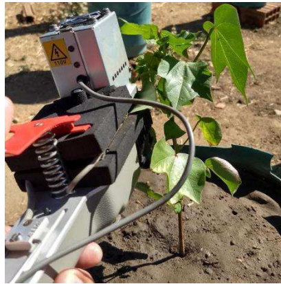
Figura 3. Utilização do IRGA (Infra Red Gás Analyser, modelo LCpro – SD, da ADC Bioscientific, UK) para avaliações das trocas gasosas do algodoeiro colorido “BRS Jade” aos 35 dias após a sementeira.
