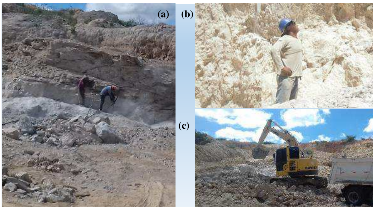
Painel 2 – Processo de extração de feldspato em Junco do Seridó
