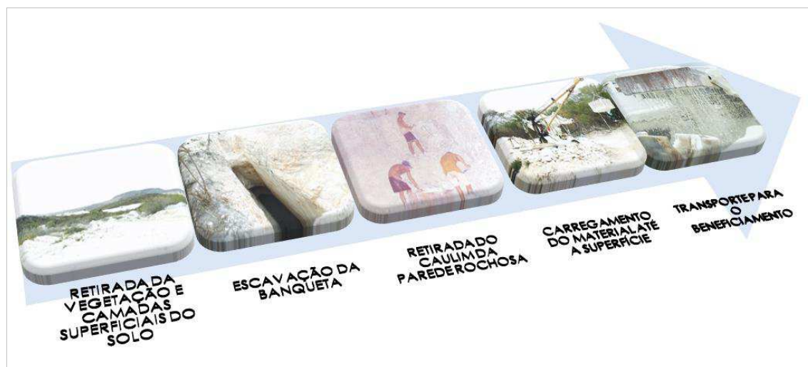
Figura 1 – Etapas do processo de extração de caulim
